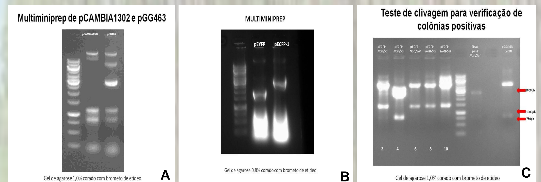
Figura 2. Análises de preparações plasmidiais de pCAMBIA1302 e pGG463 (A), e de pEYFP e pECFP (B). (C) Confirmação da identidade de plasmídeos; bandas relativas aos genes eyfp (~760 pb), ecfp (~765 pb) e mCherryFP (~765 pb) observadas em tamanho correto.
