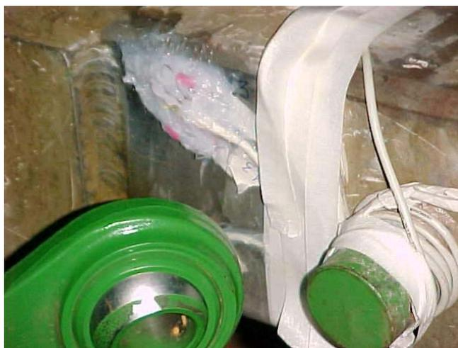
Figura 4.8 – Proteção de borracha de silicone.
