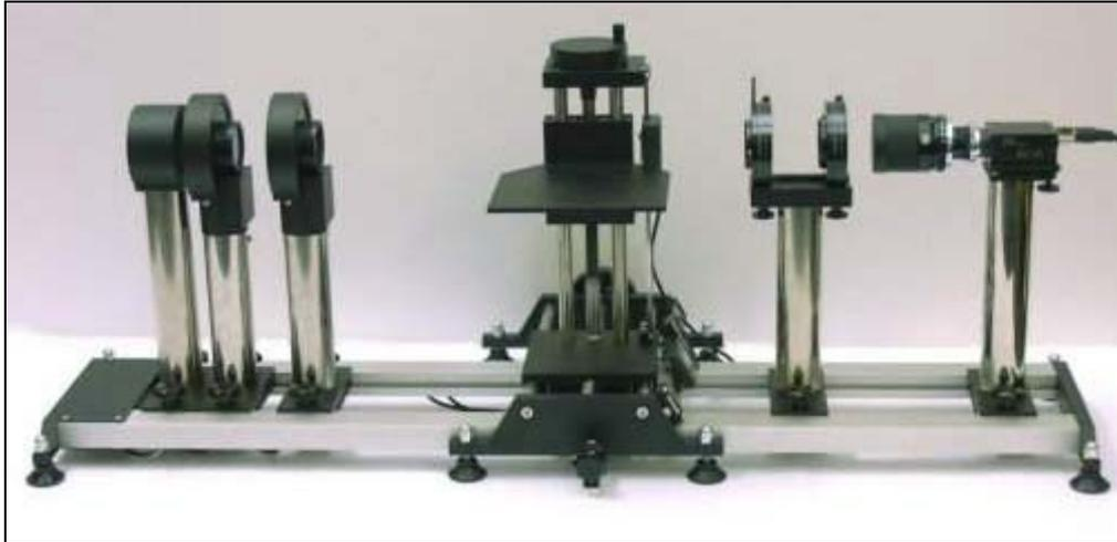
Figura 2.11 - Polariscópio para análise de modelos.
