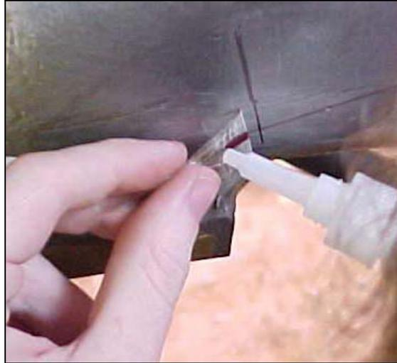
Figura 4.6 – Aplicação do adesivo sob o strain gage.
