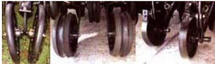
Figura 3.22 – Diferentes ferramentas usadas para o fechamento dos sulcos.
