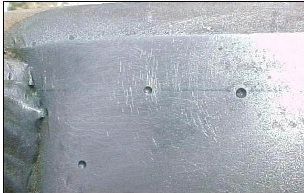
Figura 4.4 - Superfície metálica após o uso de lixas com diferentes granulometrias.
