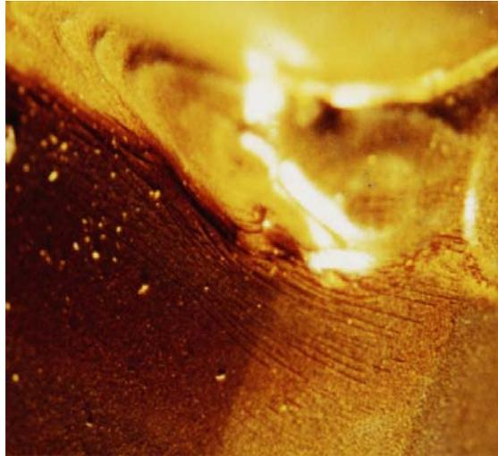
Figura 5.2 – Rugas formadas na Camada Frágil devido a compressão aplicada.
