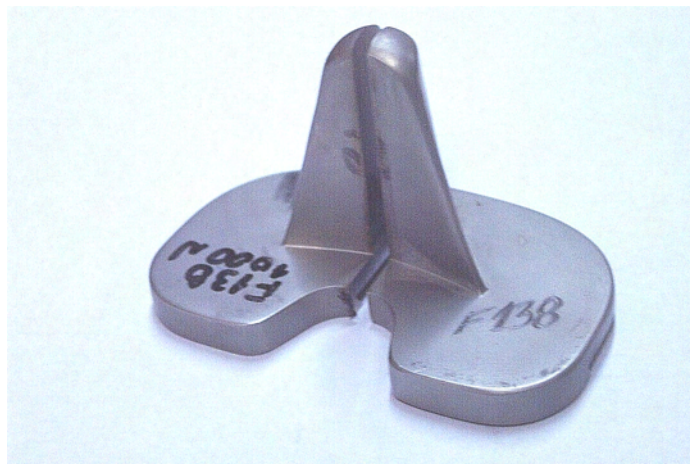
Figura 20 – Corte executado na amostra.
