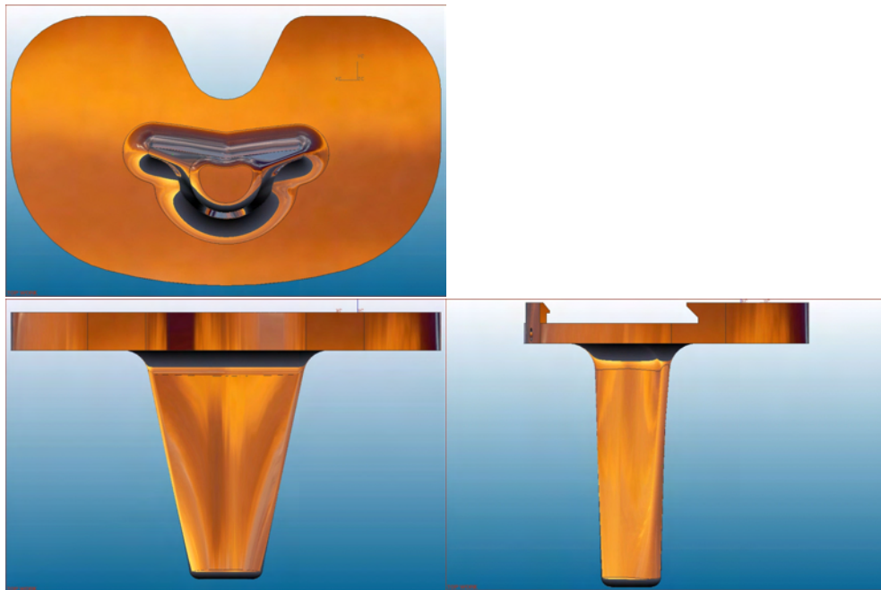
Figura 61 – Configuração Echo, mostrando o raio de concordância de 4 mm e manutenção da cota médio-lateral em 32 mm e da antero-posterior em 16 mm.
