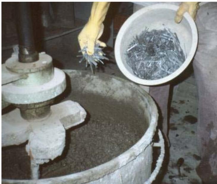
Figura 3.1 – Adição de fibras de aço na massa de concreto
