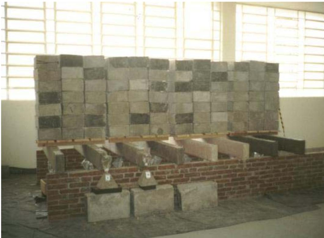
Figura 4.24 – Carregamento dos protótipos
