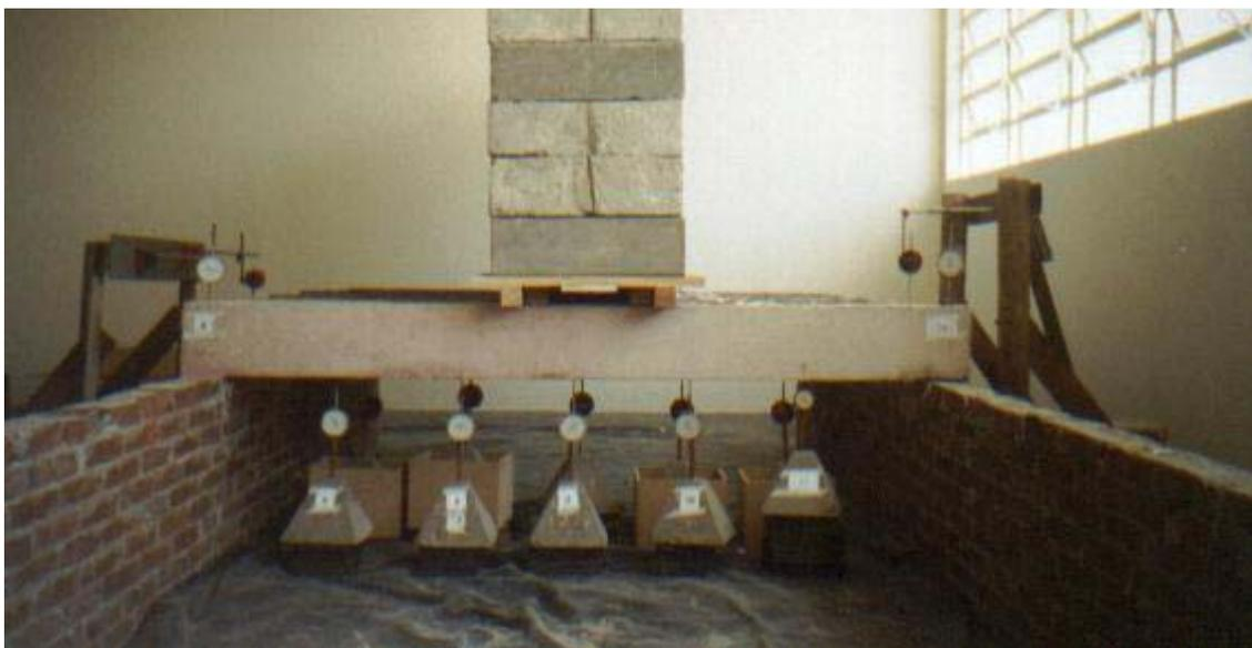
Figura 4.26 – Instrumentação para retirada do carregamento
