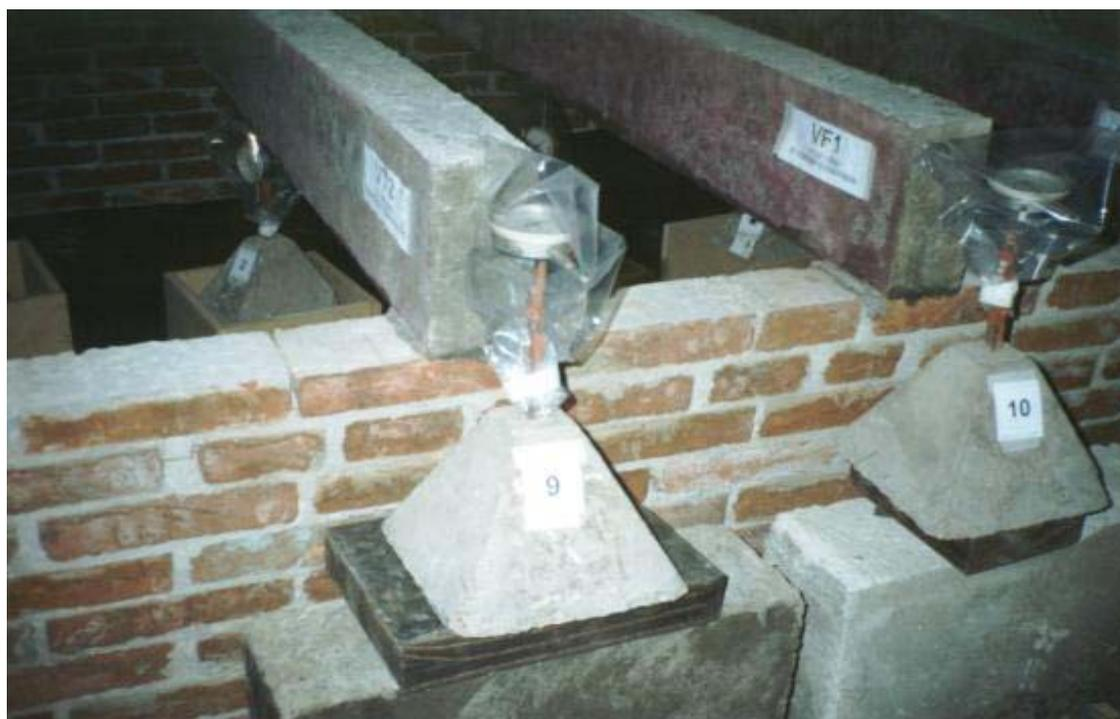
Figura 4.23 – Deflectômetros nos topos dos protótipos VT2 e VF1
