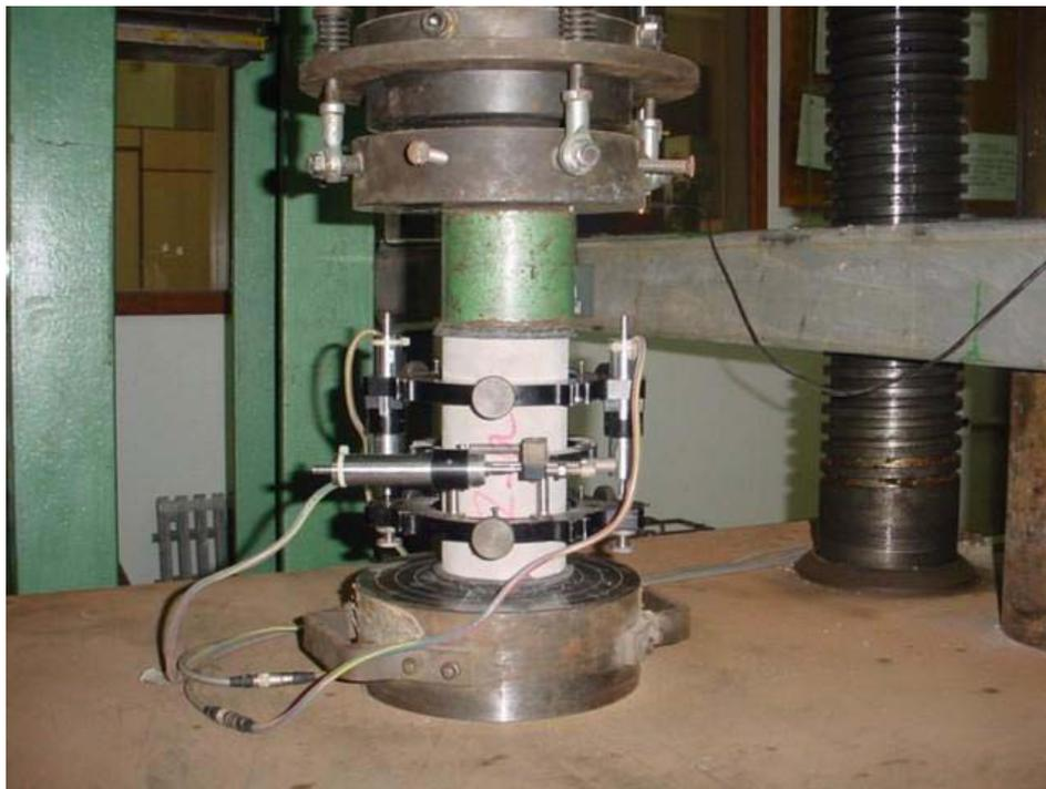
Figura 4.18 – Ensaio de Módulo de Deformação
