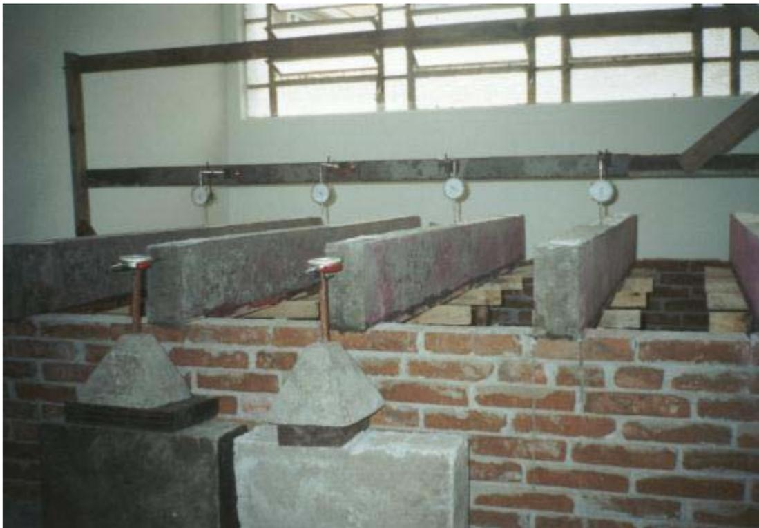
Figura 4.21 – Deflectômetros posicionados na parte superior da seção central dos protótipos e nos topos dos protótipos VT2 e VF1
