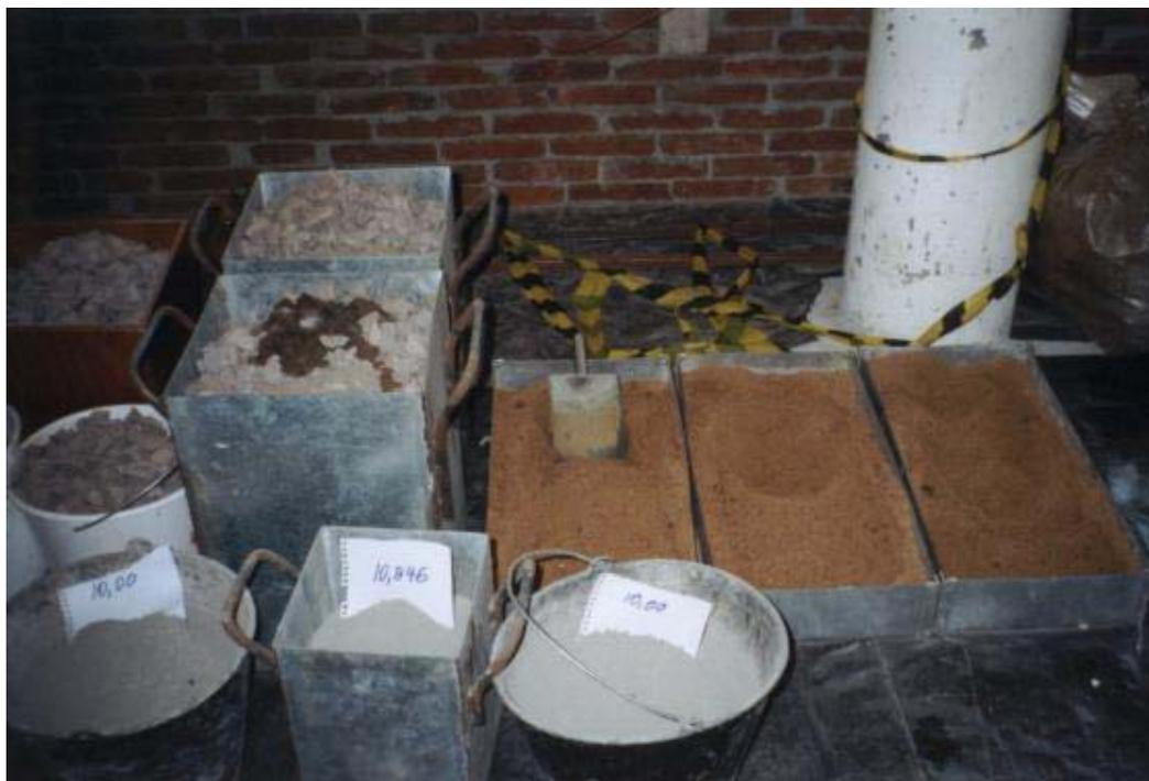
Figura 4.7 – Materiais pesados para o concreto traço I
