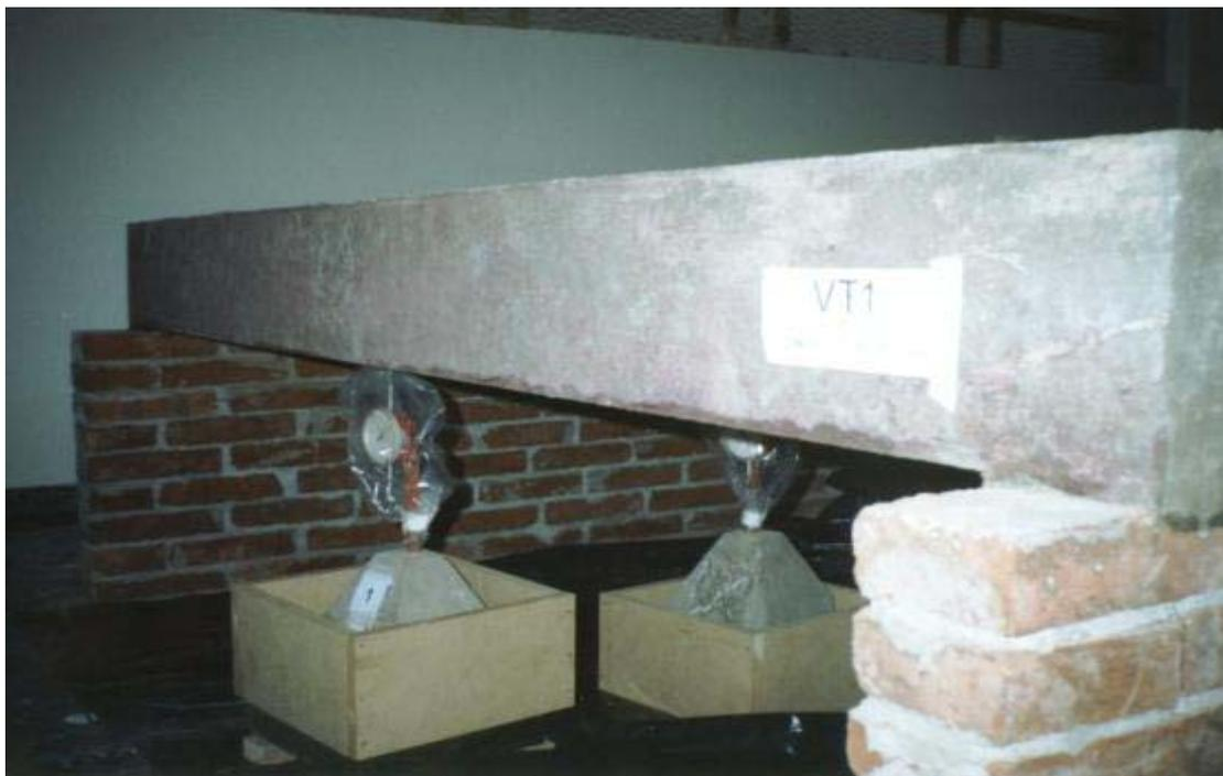
Figura 4.22 – Deflectômetros posicionados na parte inferior da seção central dos protótipos
