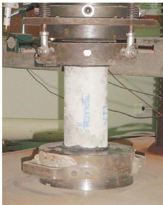
Figura 4.17 – Ensaio de Resistência à Compressão
