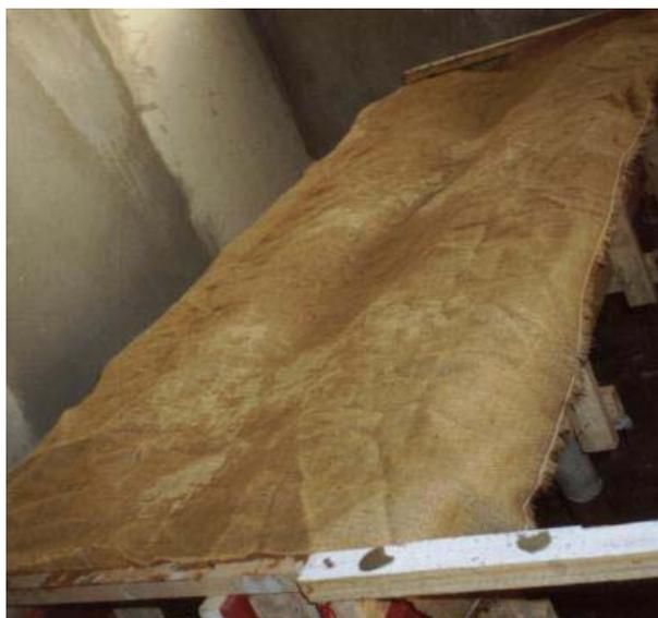
Figura 4.14– Cura dos protótipos
