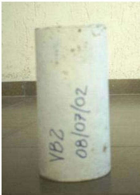
Figura 3.3 – Corpo de prova de concreto branco
