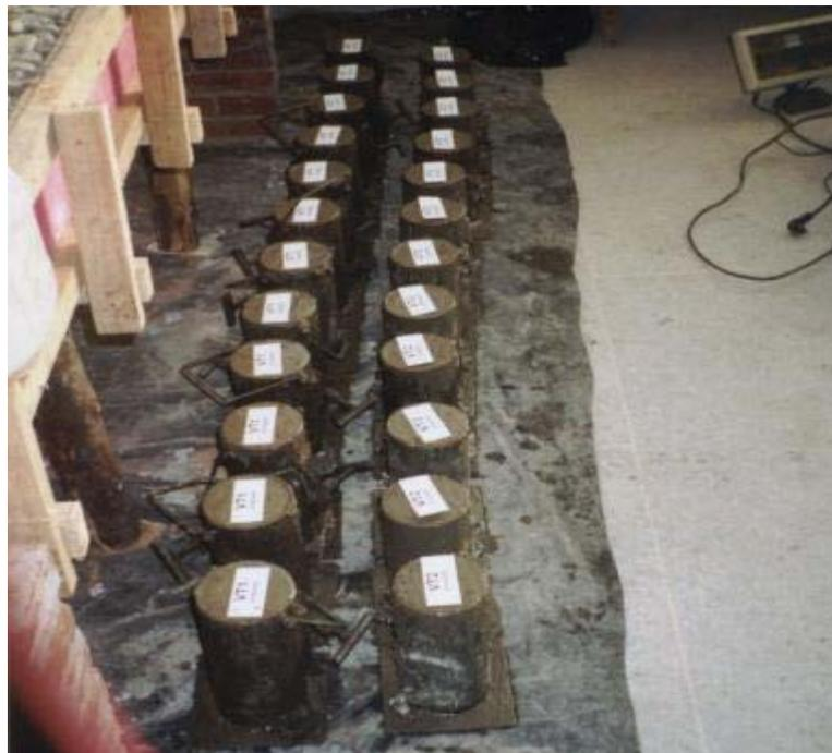
Figura 4.9 – Corpos de prova - traço I
