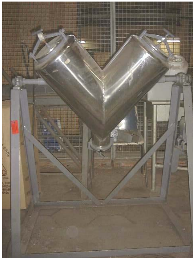
Figura 3.2: Misturador tipo Y utilizado na homogeneização da amostra cominuida
