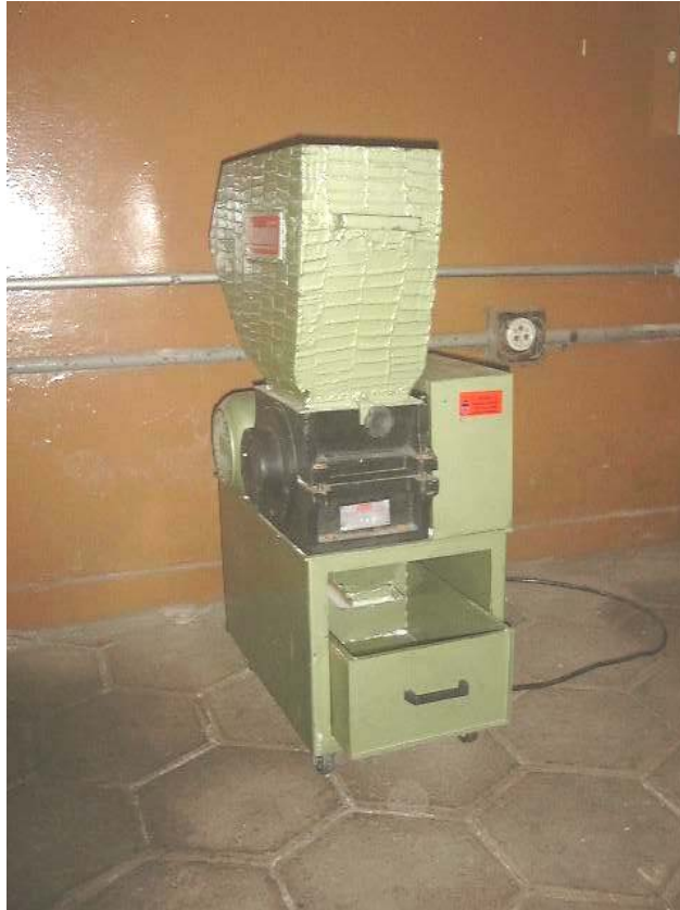
Figura 3.1: Moinho de facas utilizado na cominuição das amostras
