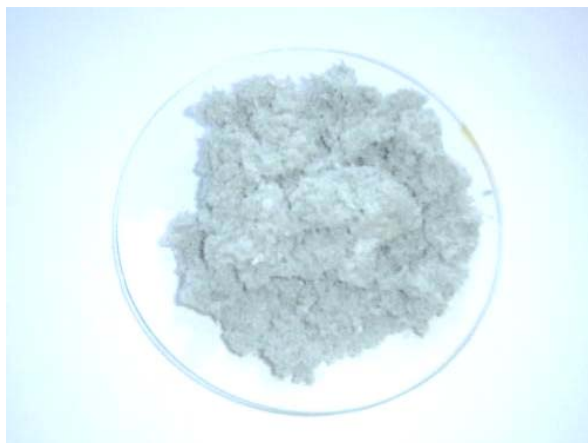
Figura 3.4: Serragem de rebaixamento na forma cominuida
