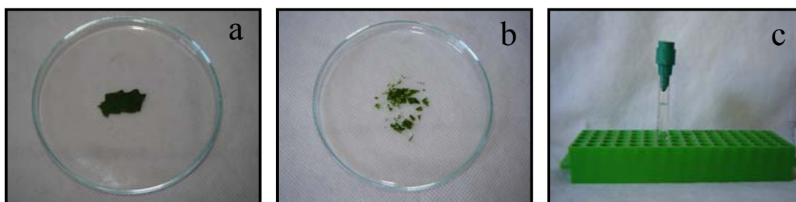
FIGURA 6. Preparo do material para análises via citometria de fluxo. a) Material vegetal ( 1\text{cm}^2 ); b) Material vegetal macerado; c) Filtragem em filtro de 30\mu\text{m} de diâmetro. IAC, Cordeirópolis - SP, 2010.
