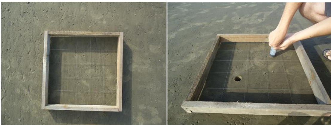
Figura 5 - Quadrado com 50cm 2 utilizado para a amostragem do sedimento, e procedimento de coleta com o testemunho de 2cm 2 . Fonte: O autor (2011).
