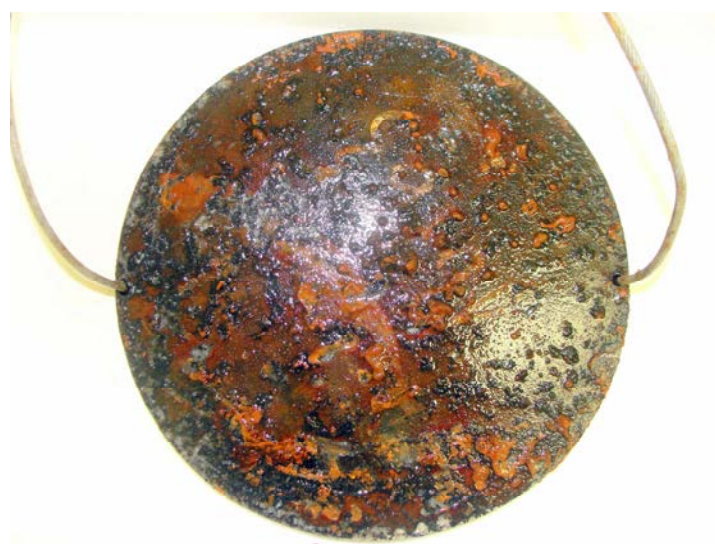
Figura 18 – Copo de prova, utilizado no experimento de colonização, em processo de corrosão com 7 dias de exposição. Fonte: autora (2011).
