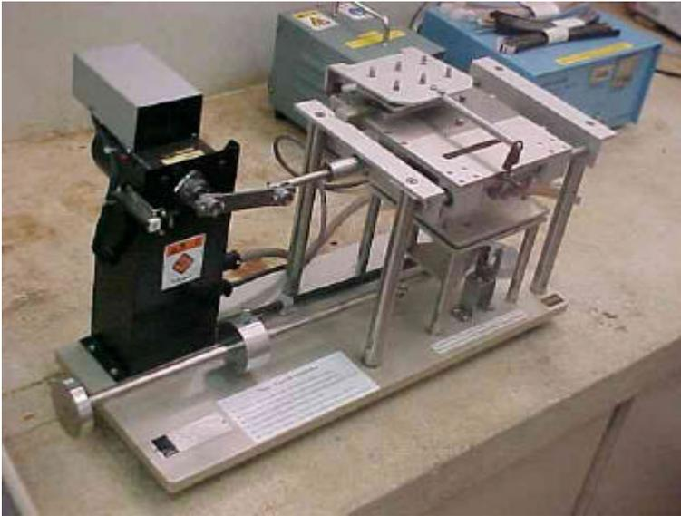
Figura 3.4 Equipamento utilizado para avaliar a resistência ao desgaste abrasivo das amostras.
