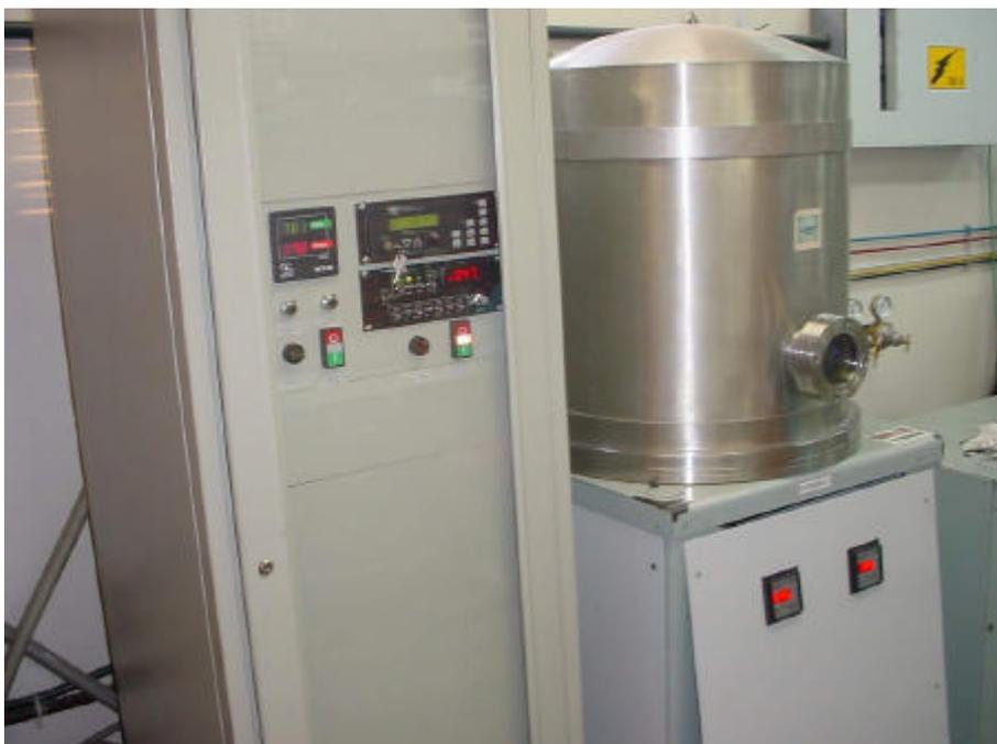
Figura 3.2 Equipamento de nitretação utilizado para o tratamento das amostras.
