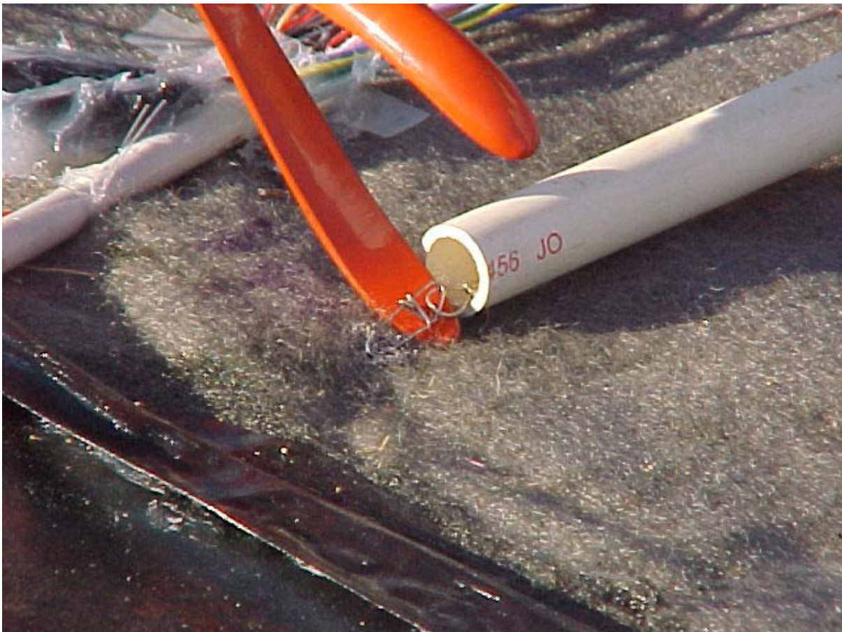
Figura 3.10 – Detalhe de fixação do tell-tail ao geotêxtil, próximo ao fim do trecho resinado, e posicionamento do fio no tubo de PVC.
