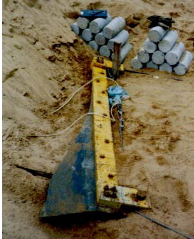
Figura 5.3 – Ruptura do geotêxtil resinado junto à garra na primeira tentativa de carregamento do geotêxtil inferior.
