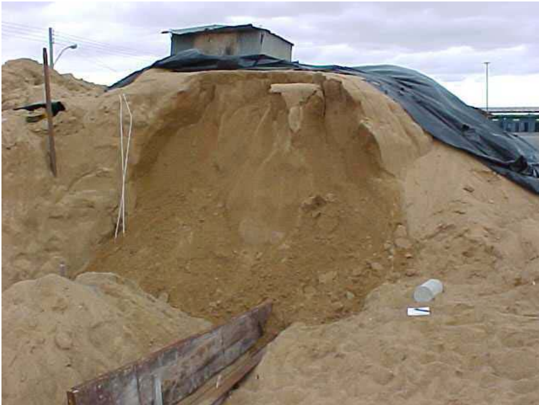
Figura 5.5 – Ruptura na face do talude durante a terceira tentativa de ensaio do geotêxtil inferior.
