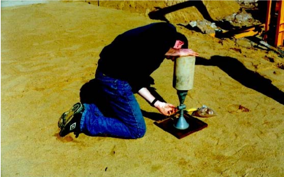
Figura 3.15 – Ensaio de cone de areia para controle de compactação do aterro.
