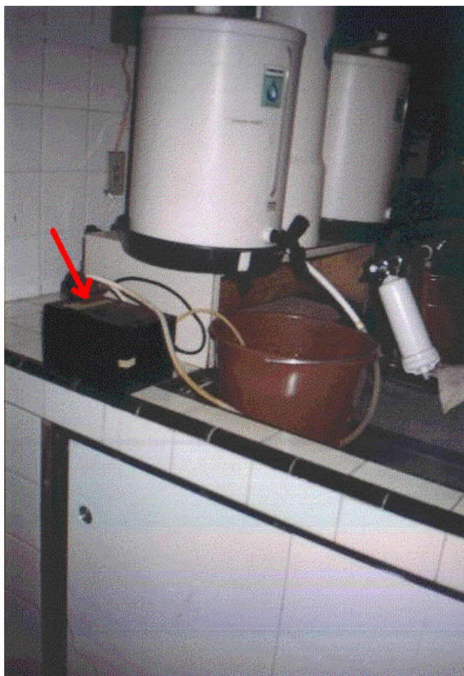
Figura 4: Bomba d’água para transferência da água residuária da lavagem da vidraria para o deionizador
