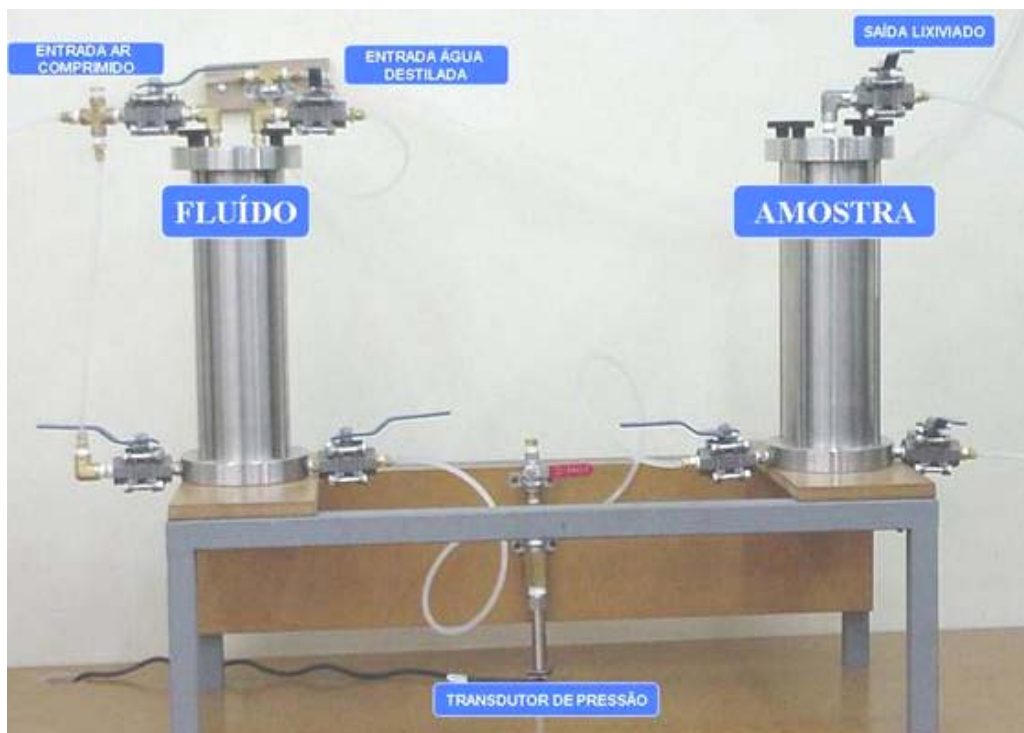
Figura 3.7 – Equipamento de lixiviação em coluna - ENVIRONGEO / UFRGS.
