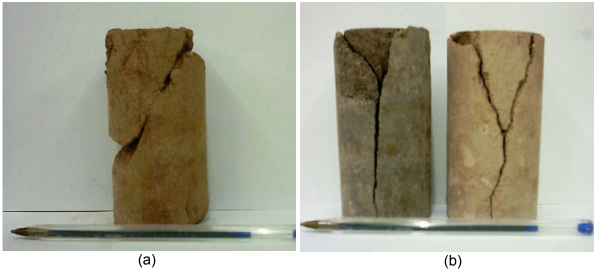
Figura 4.3 – Modo de ruptura dos corpos de prova: (a) baixa cimentação e alta concentração de contaminantes; (b) média a alta cimentação e baixa a média concentração de contaminantes.
