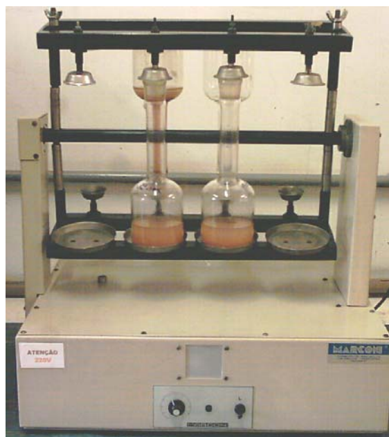
Figura 3.9 – Equipamento de lixiviação sugerido pela ABNT, do LAGEAMB/UFRGS.
