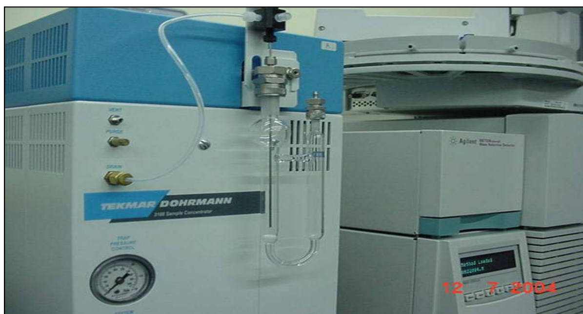
Figura 1: Ilustração de um pré-concentrador Purge and Trap .
