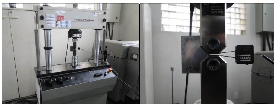
Figura 4.3: A esquerda, A MTS 810, com capacidade de 100kN, utilizada nos testes, e, a direita, o corpo de prova do tipo “CT” utilizado nos ensaios.
