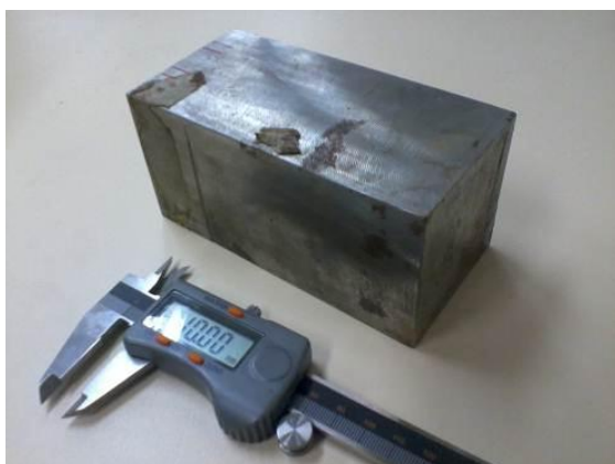
Figura 4.1: Barra do aço API 2H grau 50. Figura 4.2: Desenho do corpo de prova do tipo CT.
