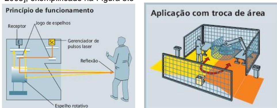
Figura 3.5 – Sistema de reflexão difusa de um scanner de área e aplicação [Siemens, 2005].
