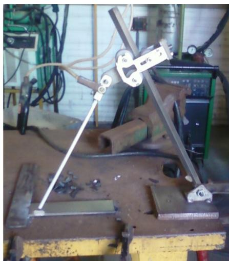
Figura 3.2 - Equipamento para soldagem por gravidade.
