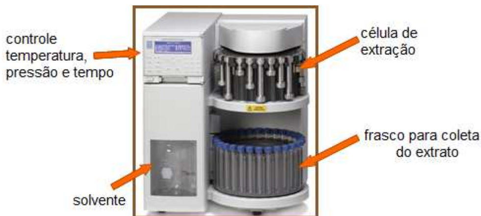
Figura 8: Foto do equipamento de extração acelerada com solvente indicando as suas partes.
