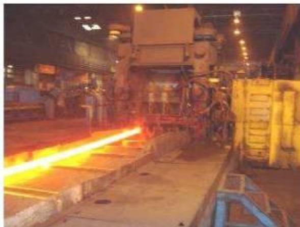
Figura 14 - Gaiola trio do laminador 2 da Gerdau AEP de arranjo aberto (20).
