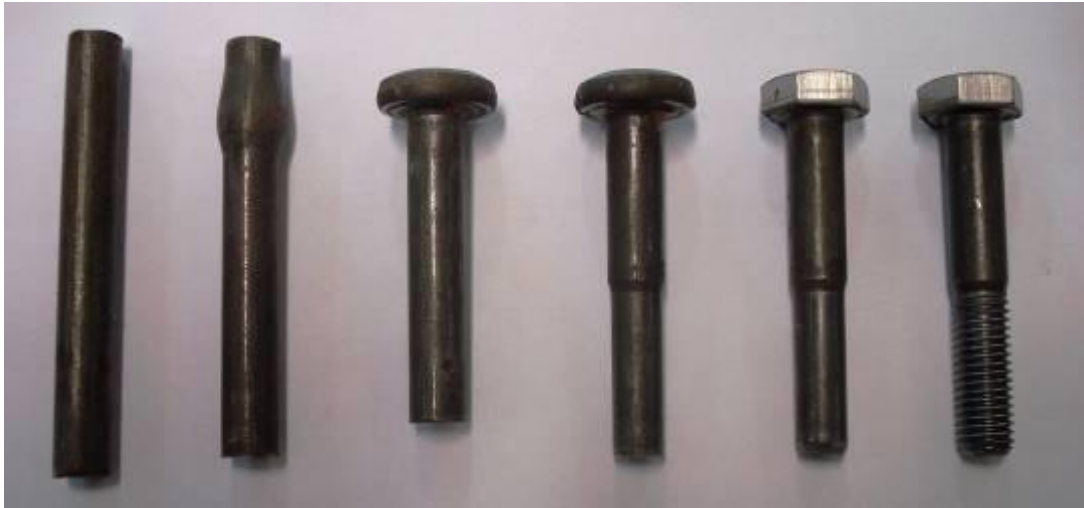
Figura 7 - Fases de estampagem de um parafuso em uma prensa de matriz sólida.
