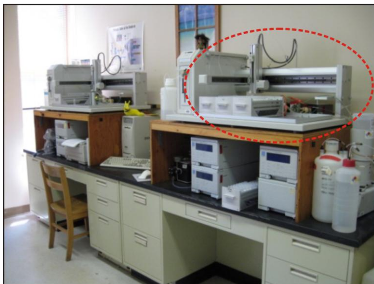
Figura 3.21: Sistema de cromatografia iônica utilizados pelo laboratório do CCI, Universidade do Maine, composto por: 2 amostradores ( passer ), computador e dois cromatógrafos. Em detalhe, a introdução das amostras no sistema com a utilização do passer .
