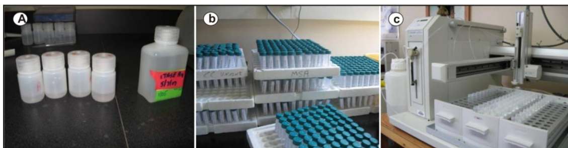
Figura 3.22: a) Mostroário padrão líquido utilizado para a calibração dos cromatógrafos; b) Frascos com amostras de IC oriundas do derretimento contínuo; c) Posicionamento das amostras e suprimento automático pelo aparelho para a análise simultânea de ânions e cátions.
