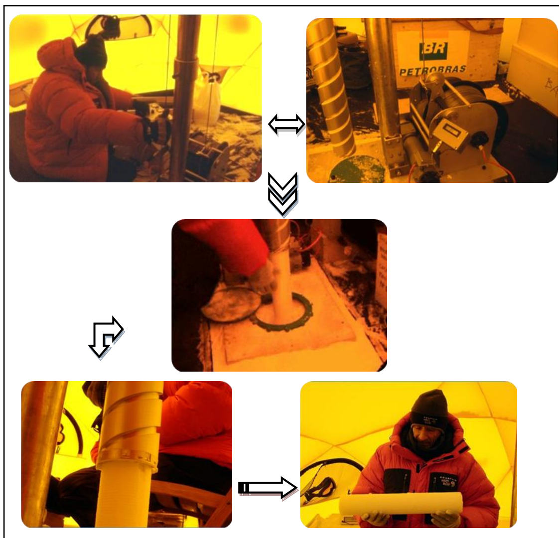
Figura 3.4: Equipamento de perfuração montado dentro de uma barraca (motor, cabo de aço, broca perfuradora de gelo (esquerda), na direita o motor e cabo de aço do equipamento (foto canto superior direito), e por fim (foto canto inferior direito) uma seção testemunho saído da perfuradora de gelo. Fonte: Jefferson C. Simões.
