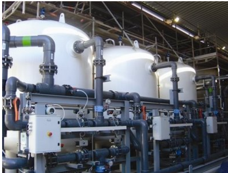
Figura 2.7: Tanques de Osmose Inversa projetados para dessalinização da água do mar.
