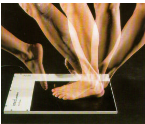
Figura 1.3 - Plataforma de força em situação de análise de caminhada. Fotografia ilustrativa, extraída de catálogo da Novel (emed).
