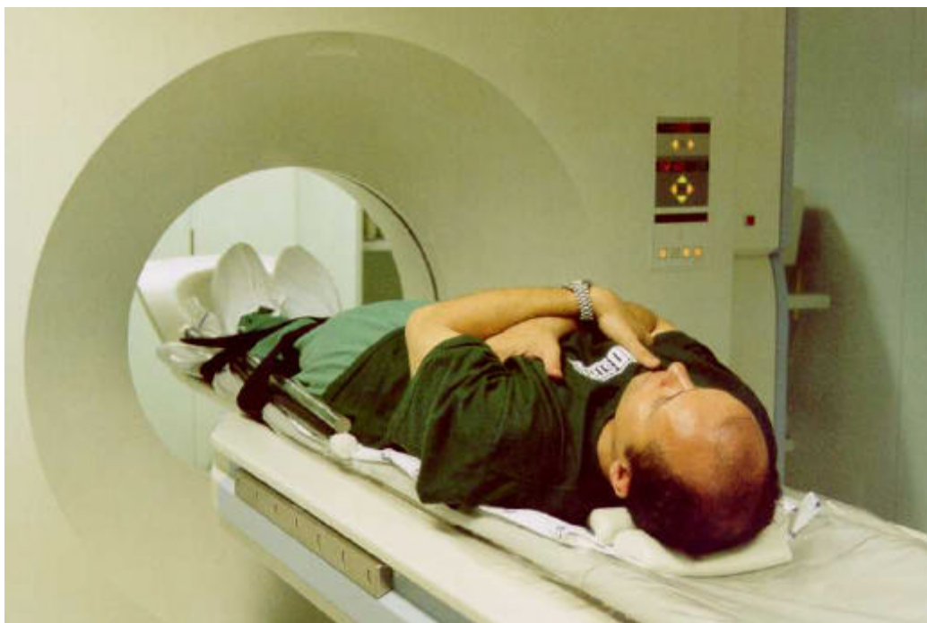
Figura 3.2.5.4 - Testes realizados no Tomógrafo Computadorizado do Centro de Diagnóstico por Imagens do Hospital São Lucas. A esquerda do voluntário os cilindros utilizados com materiais de densidade conhecida.
