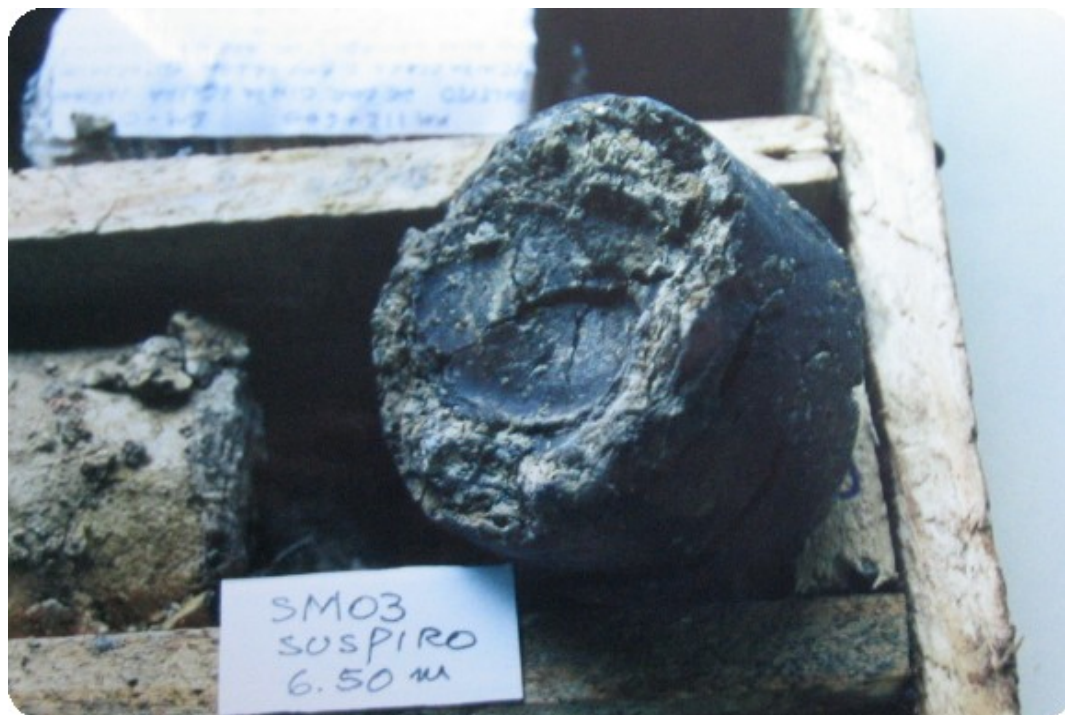
Figura A.6 – Testemunho da Sondagem SM -03, profundidade 6,50m (Argilito cinza escuro, lente intermediária).
