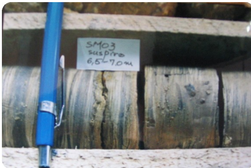
Figura A.7 – Testemunho da Sondagem, SM - 03 profundidade 6,50 – 7,00m (Silito cor cinza-escuro variando para cinza amarelado intercalado interface da lente intermediária de argilito).
