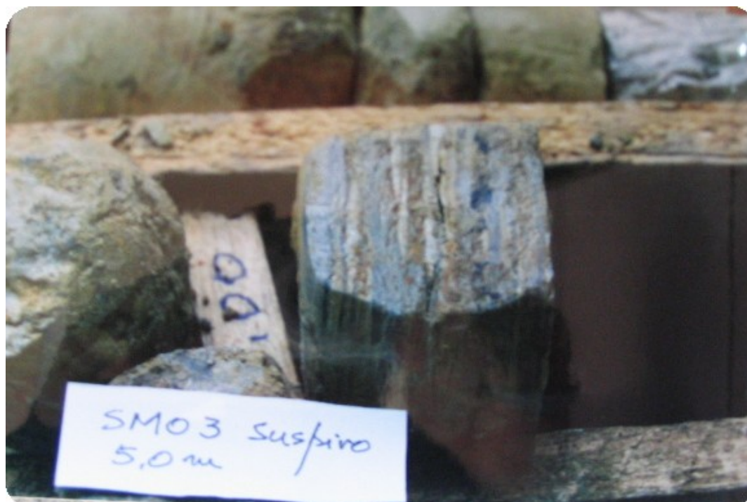
Figura A.4 – Testemunho da Sondagem SM -03, profundidade 5,0m (Siltito cor cinza-escuro variando para cinza amarelado intercalado – várias camadas de material sedimentar).
