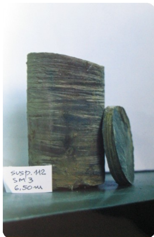
Figura A.5 – Testemunho da Sondagem SM -03, profundidade 6,50m (Siltito cor cinza-escuro variando para cinza amarelado intercalado + lamela – várias camadas de material sedimentar).
