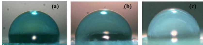
Figura 57. Ensaio da gota de água sobre área delaminada de cobre em PA 6: (a) normal, (b) flambado e (c) lixado.
