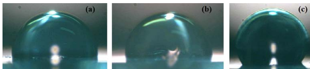
Figura 32. Ensaio da gota de água sobre cobre em PET: (a) normal, (b) flambado e (c) lixado.
