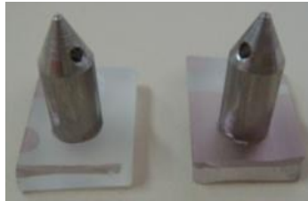
Figura 21. Amostra filme metálico: área circular e retangular abaixo dos pinos colados.
