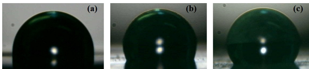
Figura 31. Ensaio da gota de água sobre cobre/PA 6: (a) normal, (b) flambado e (c) lixado.
