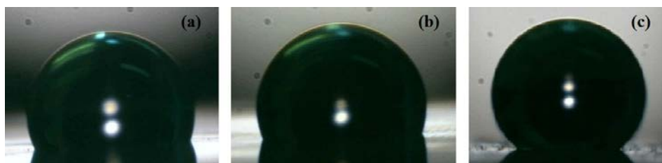
Figura 30. Ensaio da gota de água sobre cobre em PP: (a) normal, (b) flambado e (c) lixado.
