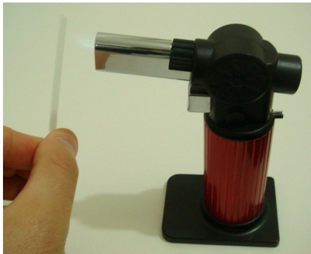
Figura 16. Processo de flambagem de polímeros antes da deposição de filme de cobre.
