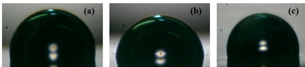
Figura 33. Ensaio da gota de água sobre cobre em HIPS: (a) normal, (b) flambado e (c) lixado.
