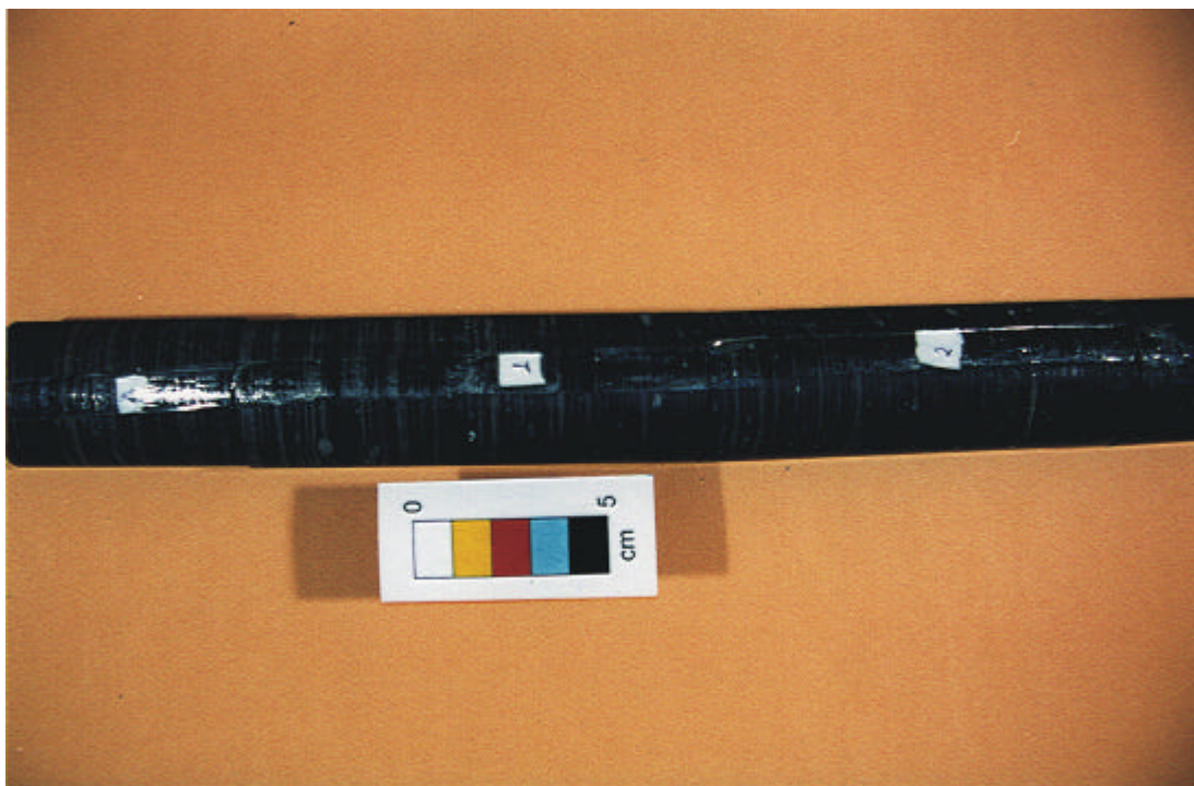
Fotografia IV.24 – Pequeno intervalo do testemunho do poço 7-RL-04-SC, mostrando três trechos unidos com fita gomada, identificados como A, 1 e 2, à caneta.
