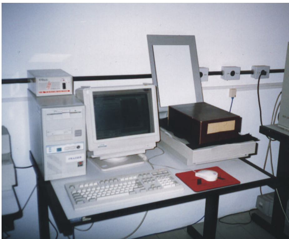
Fotografia IV.23 – Scanner coberto com a caixa de papelão. Notar o feltro preto nas laterais do aparelho, impedindo a entrada de luz.
