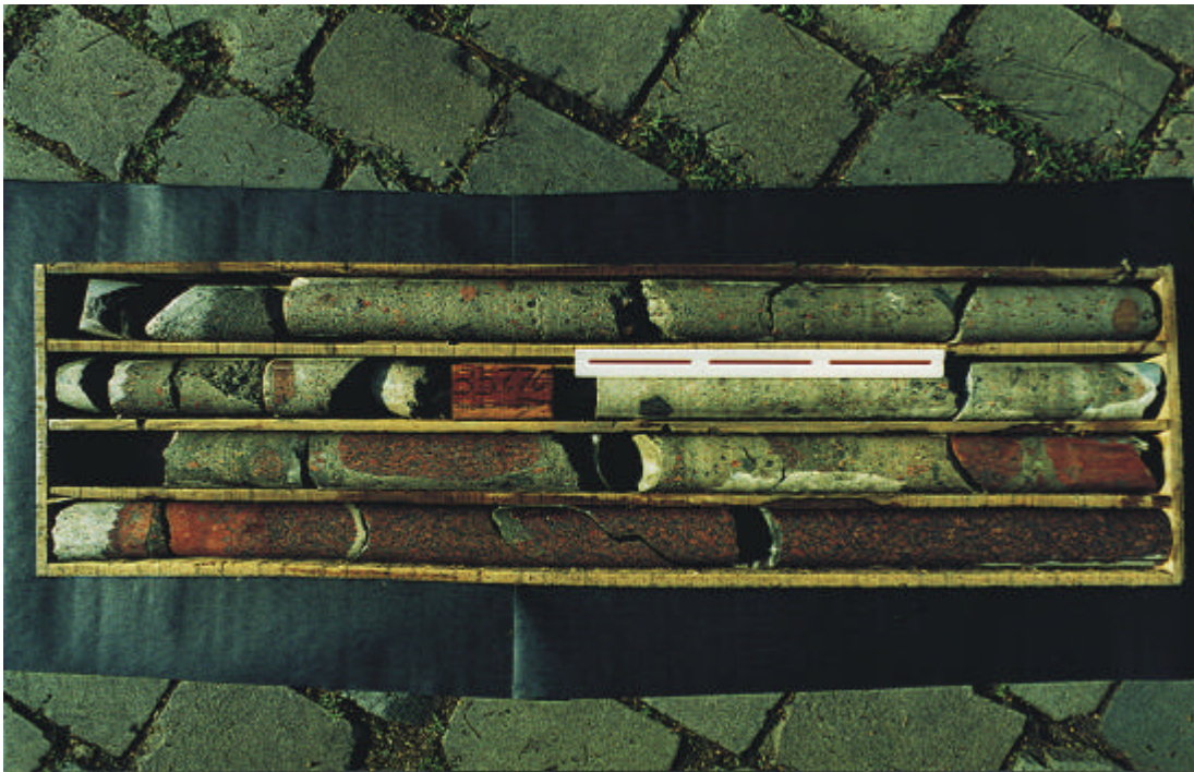
Fotografia IV.12 – Diamictito da base do poço IB-93-RS, com matriz arenosa e clastos de granito e K-feldspato. A régua tem 32 cm de comprimento (Cortesia da geóloga Ariane da Silveira).
