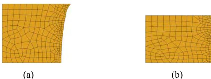
Figura 5.60. Peça otimizada pelo NLPQLP: (a) pré-forma e (b) deformada final.
