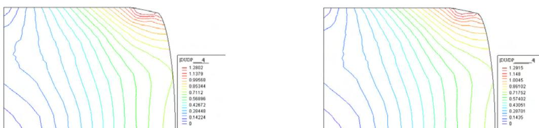
Figura 4.55. Campo de sensibilidade da norma dos deslocamentos com relação ao raio  $R_1$ .
