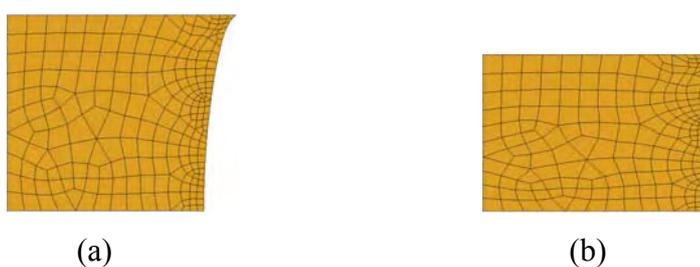
Figura 5.59. Peça otimizada pelo GCMMA: (a) pré-forma e (b) deformada final.
