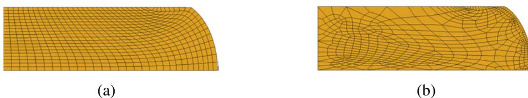
Figura 4.32. Domínio de análise: (a) Malha estruturada deformada e (b) malha não estruturada deformada.
