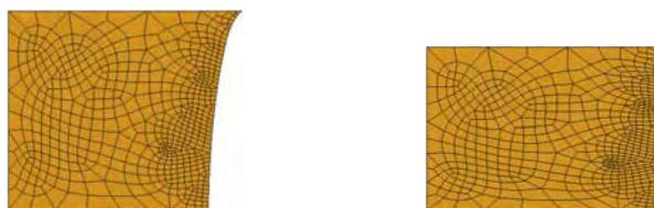
Figura 5.49. Pré-forma otimizada e peça forjada (GCMMA com regeneração de malha).
