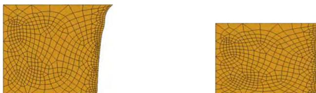
Figura 5.46. Pré-forma otimizada usando suavização Laplaciana potência inversa ( $p=1.5$ ): diferenças finitas globais.
