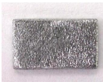
Figura 3.6 Amostra para determinação do conteúdo total de hidrogênio após preparação superficial.
