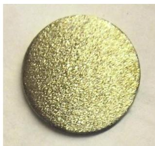
Figura 3.8 Amostra para determinação de hidrogênio difusível após preparação superficial.
