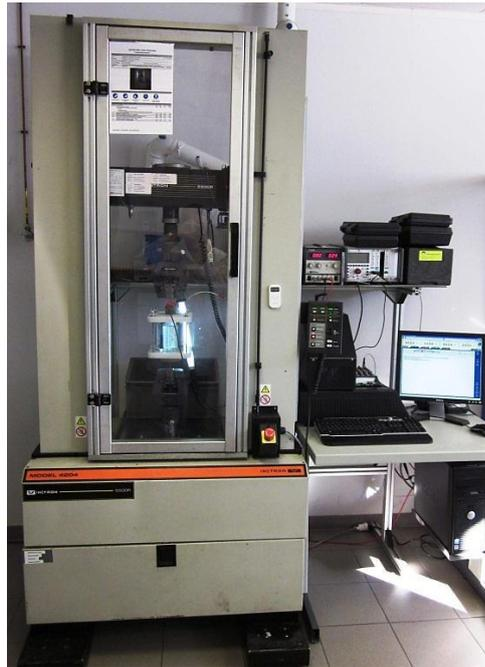
Figura 3.13 Equipamento utilizado na realização dos ensaios de tração uniaxial.
