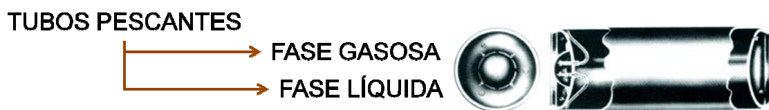
Figura 8. Esquema interno do cilindro de cloro.
