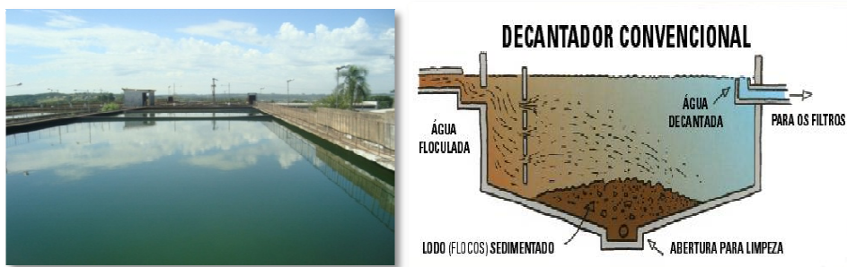
Figura 3. Foto e desenho esquemático de decantador.
