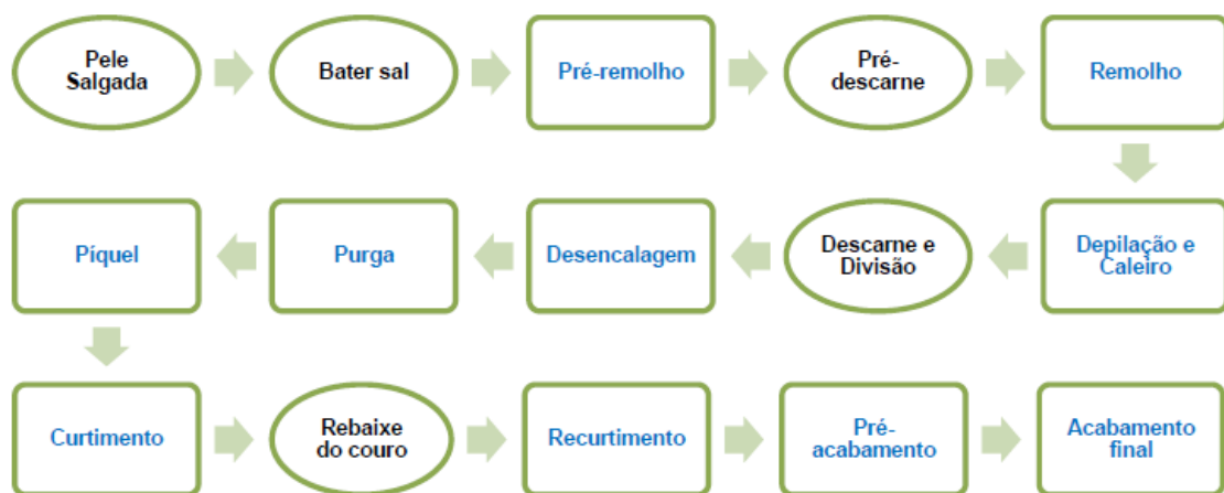
Figura 1: Fluxograma de processamento do couro (as etapas descritas em retângulos indicam que o processo ocorre em meio aquoso) Fonte: Souza (2010)
