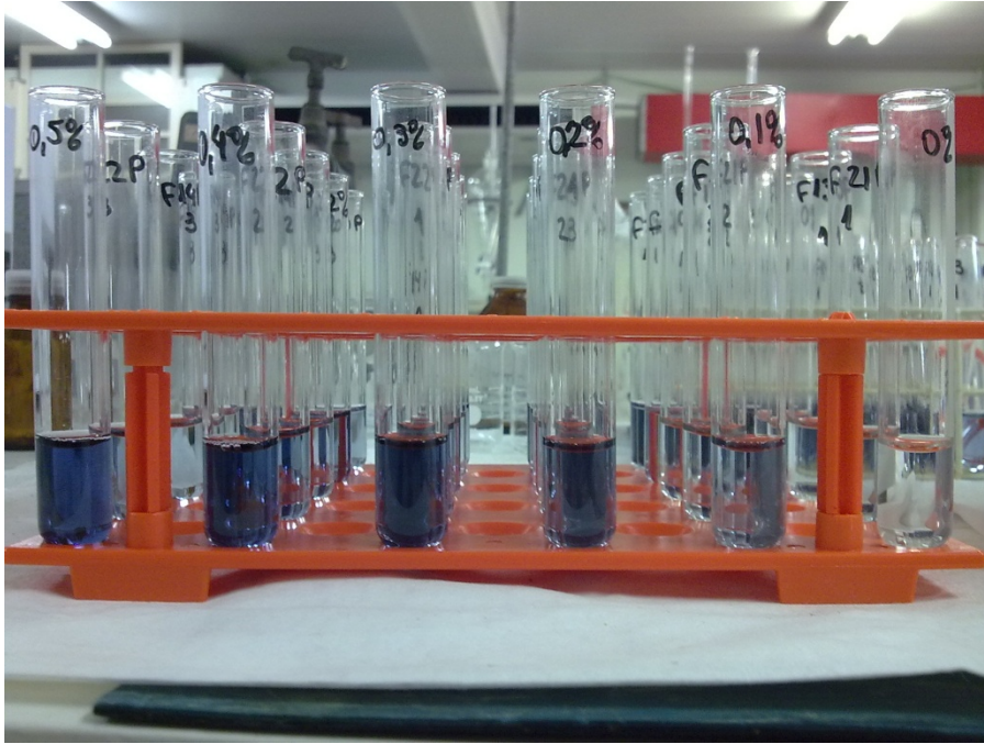
Figura 7: Construção da curva padrão de PS
