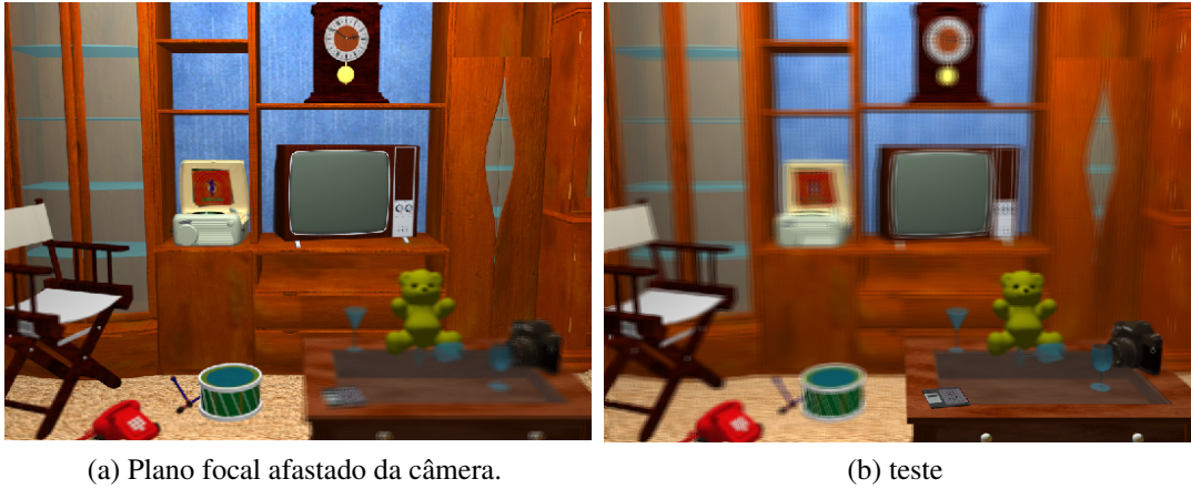
Figura 5.8: Simulação de abertura sintética com a câmera compacta com espaçamento pequeno entre as lentes. Utilizando somente as seis imagens capturadas.
