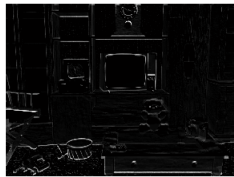
(d) Erro mínimo quadrático entre as imagens (a) e (b). Supondo que suas intensidades podem ser escaladas linearmente
