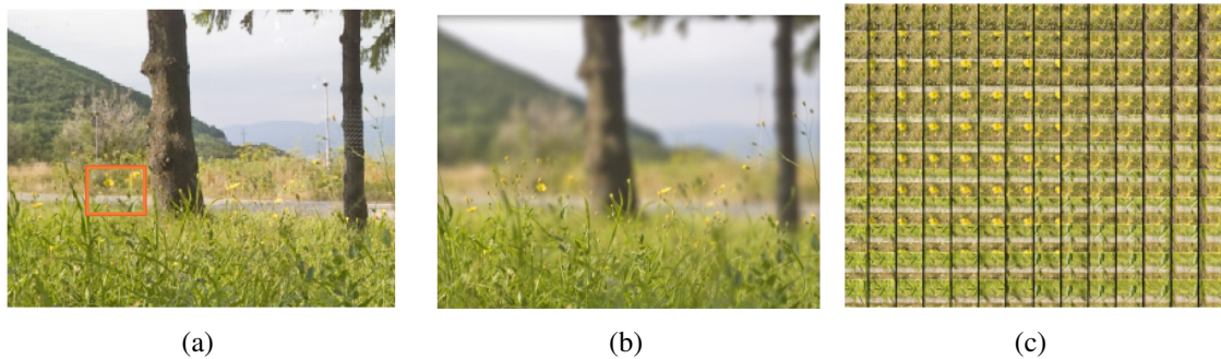
Figura 3.14: Resultados obtidos com a Câmera Plenótica 2.0. (a) Abertura sintética com plano focal próximo a câmera. (b) Abertura sintética com plano focal afastado da câmera. (c) Recorte da imagem bruta capturada com a plenótica 2.0, referente a posição indicada pelo retângulo vermelho em (a) (Georgiev e Lumsdaine 2010).
