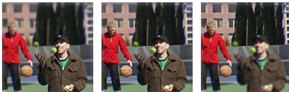
Figura 3.11: Efeito de refoco alcançado com a Light Field Camera , utilizando a técnica de view morphing (Seitz e Dyer 1996) para obter um campo luminoso denso direcionalmente. Da esquerda para direita, o plano focal move-se da frente para trás nas imagens. (Georgiev et al. 2006)
