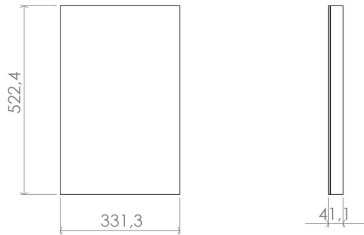
Detalhamento Chapa de acabamento - esp. 1,27mm
