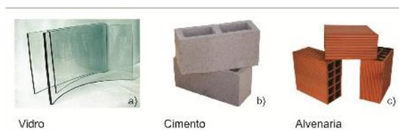
**Figura 23:** Materiais cerâmicos. Fonte: Diversas<sup>9</sup>.
