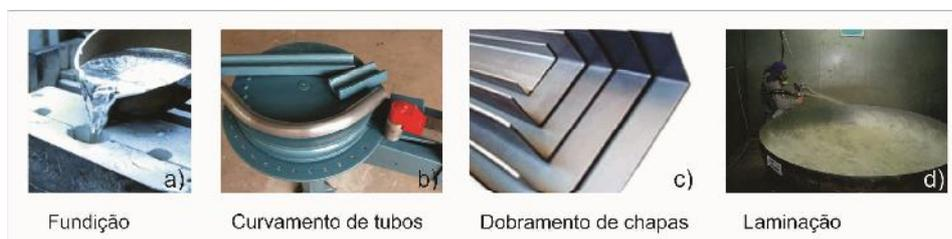
**Figura 28:** Exemplo processos de conformação. Fonte: Diversas<sup>14</sup>.
