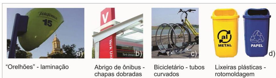
**Figura 29:** Exemplo mobiliário urbano fabricado com processos de conformação. Fonte: Diversas<sup>15</sup>.
