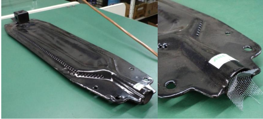
Figura 13 – Chapa Dissipadora de chama do forno, e em detalhe grelha dissipadora de gás. Fonte: Autor
