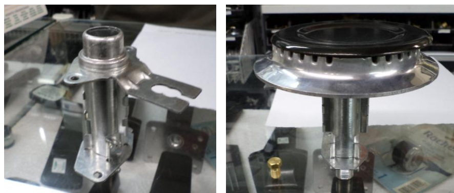
Figura 9 – Cano de proteção do tubo de gás e queimador montado. Fonte: Autor
