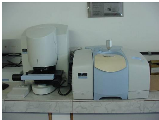
Figura 57 - Equipamento de FTIR (LdSM/UFRGS). Fonte: Acervo pessoal Luis Alves Cândido
