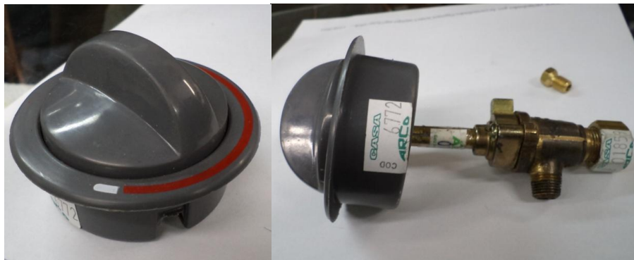
Figura 12 – Botão de controle de chama e montagem do botão com válvula injetora. Fonte: Autor
