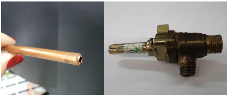
Figura 11 – Cano de cobre para passagem de gás e válvula injetora. Fonte: Autor
