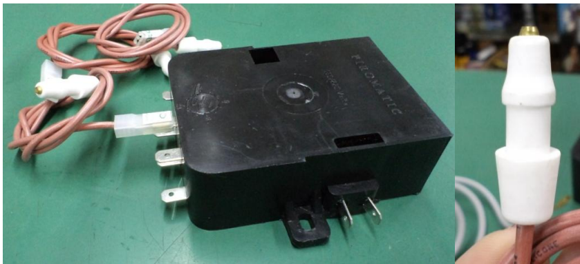
Figura 14 – Usina de ignição e vela. Fonte: Autor
