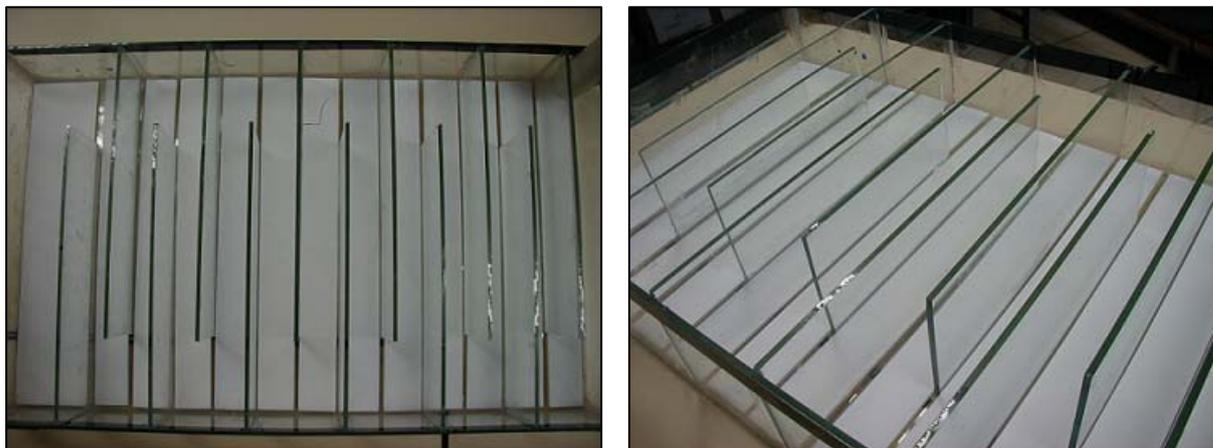
**Figura A.4:** Conjunto de placas de vidro impregnadas com  $\text{TiO}_2$  posicionadas dentro do reator de vidro do tipo labirinto
