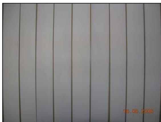
**Figura A.3:** Conjunto de placas de vidro impregnadas com  $\text{TiO}_2$ .
