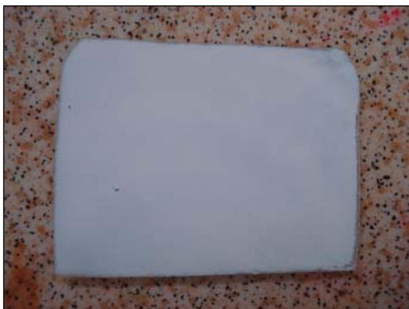
**Figura 3.3:** Visualização do filme de  $\text{TiO}_2$  impregnados sobre o suporte de vidro borossilicato
