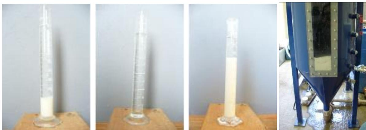
Figura 51. Fotografias das correntes de alimentação, overflow, underflow do sedimentador de lamelas e detalhe do fundo do SL com acúmulo de lodo.
