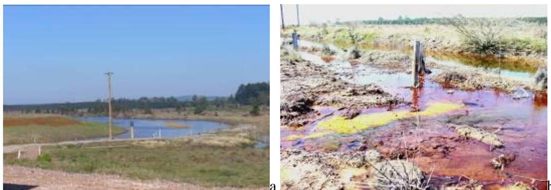
Figura 9. Drenagem ácida de Minas na localidade Capão da Roça, gerada pela oxidação de rejeito piritoso disposto na área. A) cinturão de DAM que circula a pilha de rejeito; b) detalhe do escoamento de DAM rica em elementos metálicos.
