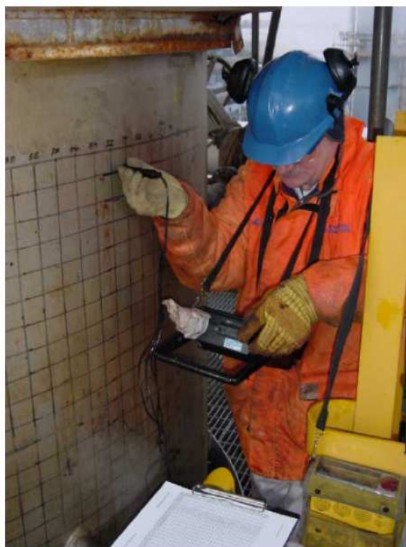
Figura 4: Malha de Pontos de Medição de Espessura, BWO Shepherd - Mitsui Babcock, HOIS Seminar, 2000.
