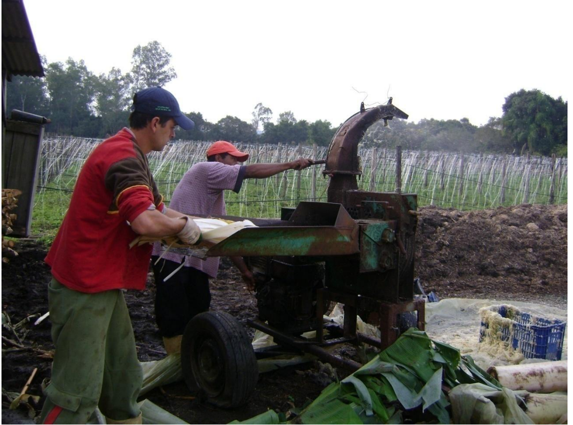
(4) Equipamento usado para triturar o resíduo das bainhas
