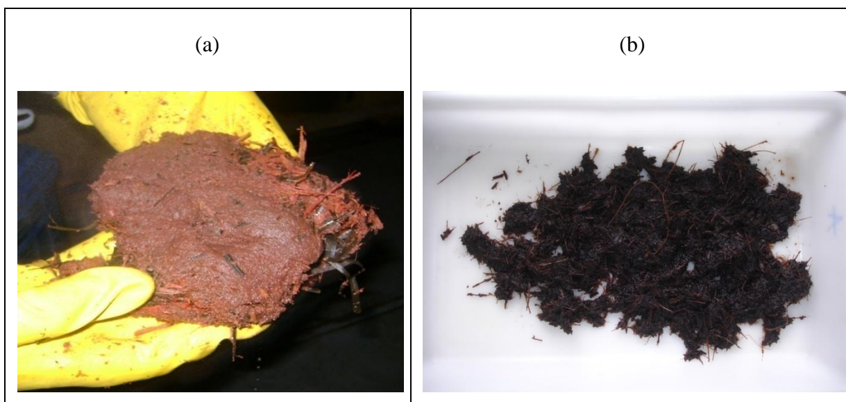
Figura 4: Material após tratamento de hidrólise ácida (a) e material após extração alcalina (b)
