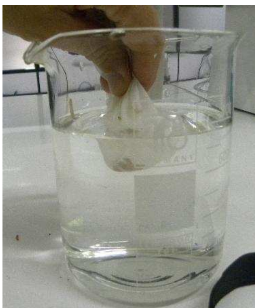
FIGURA 3: Imersão de pupas de G. molesta em solução de óleo de citronela com tecido voile
