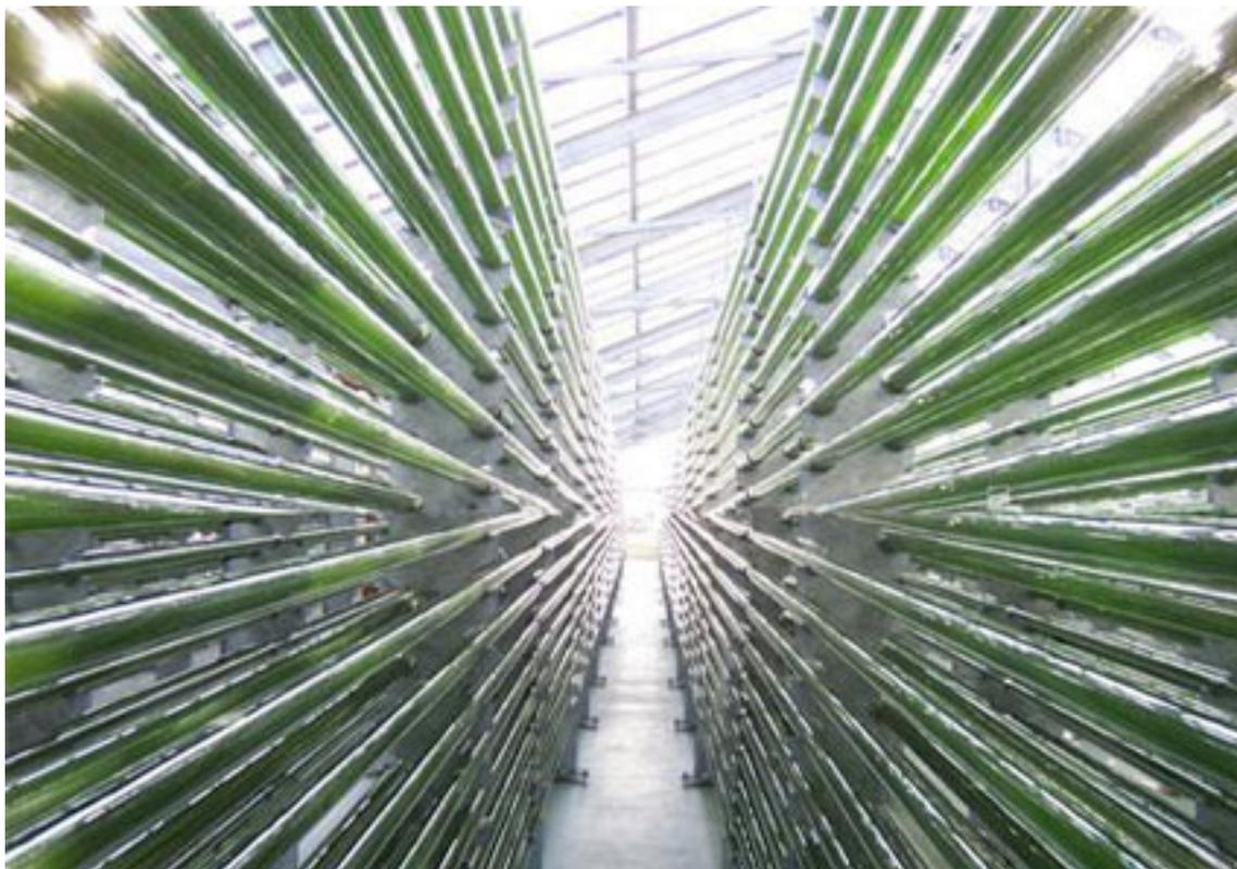
**Figura 4 – Conjunto de fotobiorreatores tubular em Klötze, Alemanha**
