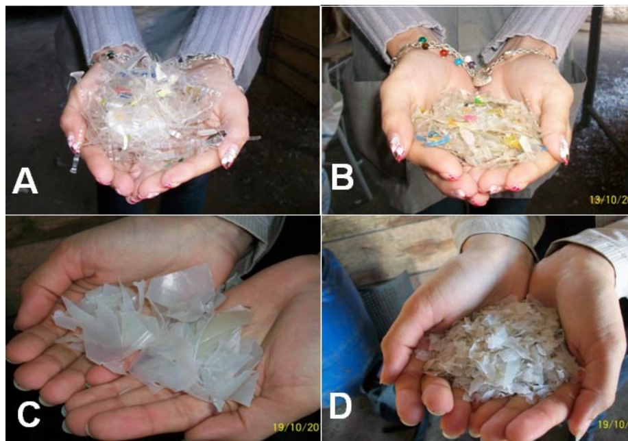
Figura 4.10 – Plástico saído do primeiro moinho de facas (A) PP transparente e (C) PEAD branco. Plástico saído do segundo moinho de facas (B) PP transparente e (D) PEAD branco.
