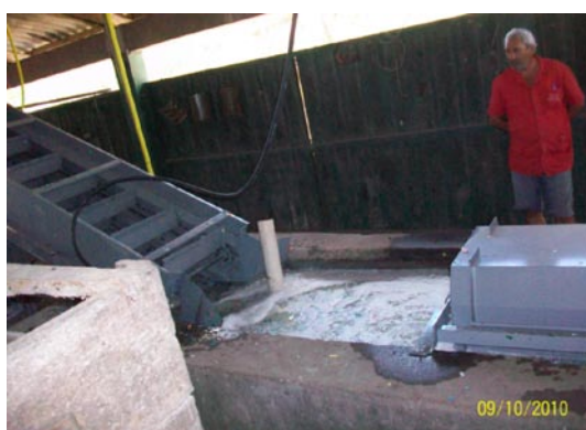
Figura 2.14 – Tanque do processo de reciclagem mecânica. À direita encontra-se o agitador, e à esquerda a esteira.
