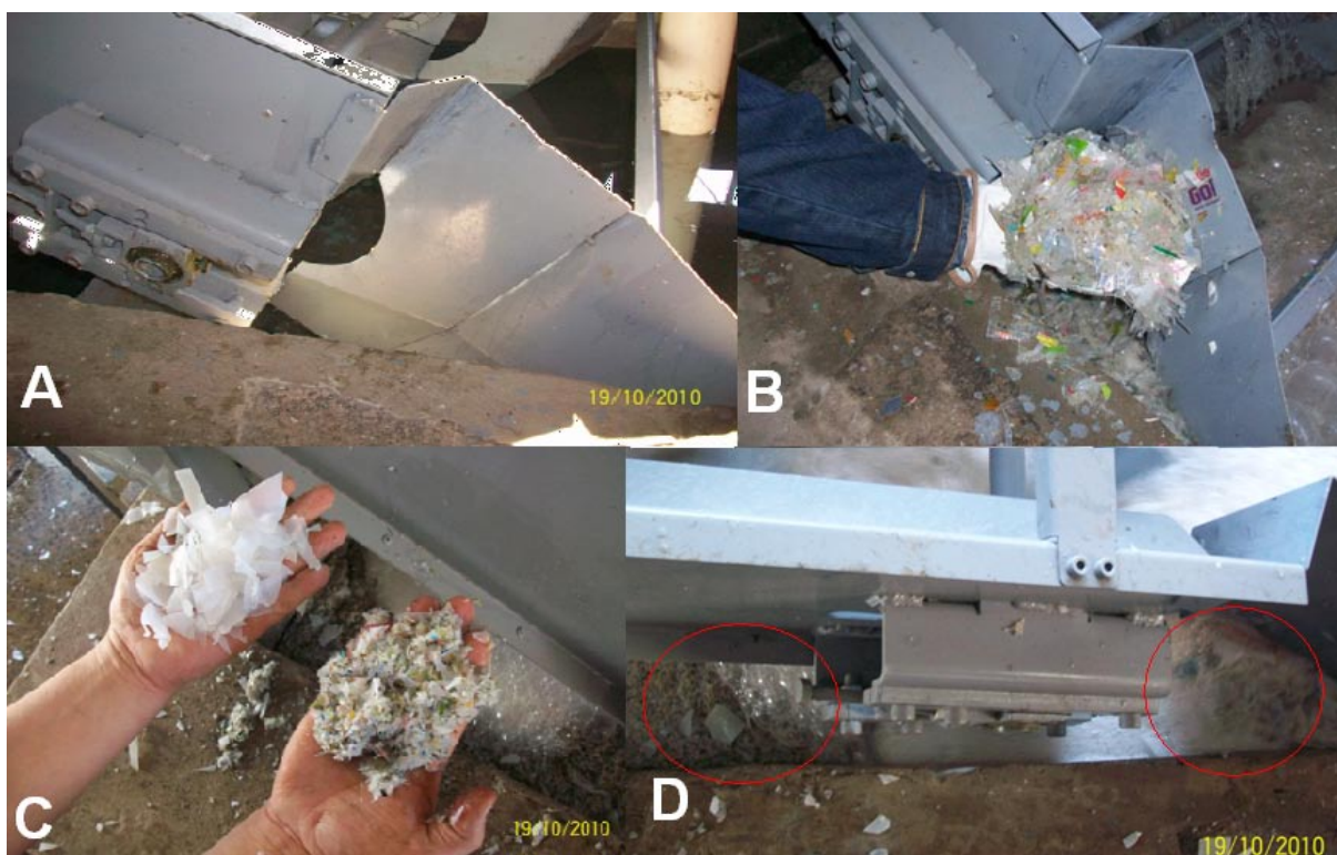
Figura 4.5 – (A) Vista lateral da esteira; (B) Material encontrado no ponto de acúmulo da esquerda; (C) Comparação da granulometria do material saído do processo e retido nos pontos de acúmulo; (D) Pontos de acúmulo entre o tanque e a esteira.
