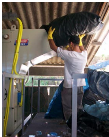
Figura 2.13 – Alimentação manual do Moinho de facas
