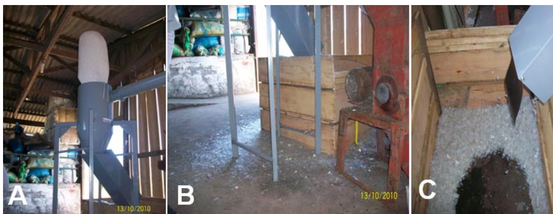
Figura 4.9 – (A) Ciclone; (B) Visão do material fora da caixa de recebimento do ciclone; (C) Visão do aparador na saída do ciclone.
