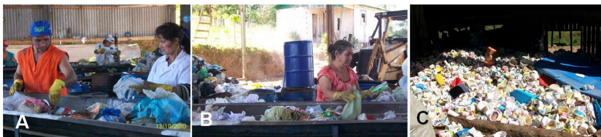
Figura 2.12 – (A) e (B) Processo de triagem manual no CT de Nova Hartz; (C) Potes de margarina de PP.
