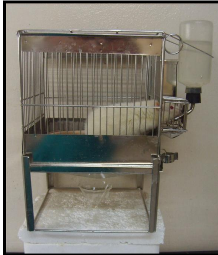
Figura 4: Coleta de urina em gaiola metabólica. O rato previamente selecionado permanecia 24 horas na gaiola metabólica com água e comida à vontade. A urina foi coletada em um recipiente refrigerado e em seguida congelada até a realização do experimento.
