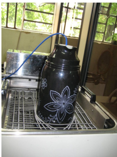
Figura 3.2 – Fotografia do calorímetro imerso em banho com agitação.
