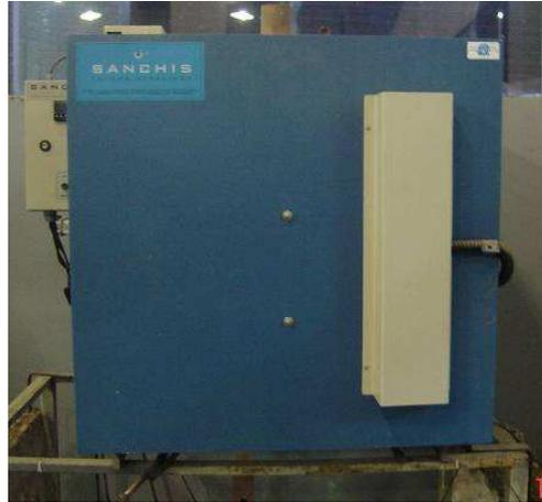
Figura 5.52 – Forno elétrico utilizado no aquecimento das fibras com temperaturas de 400°C e 600°C.
