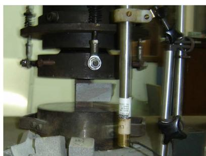
Figura 4.10 – Ensaio de resistência à compressão.
