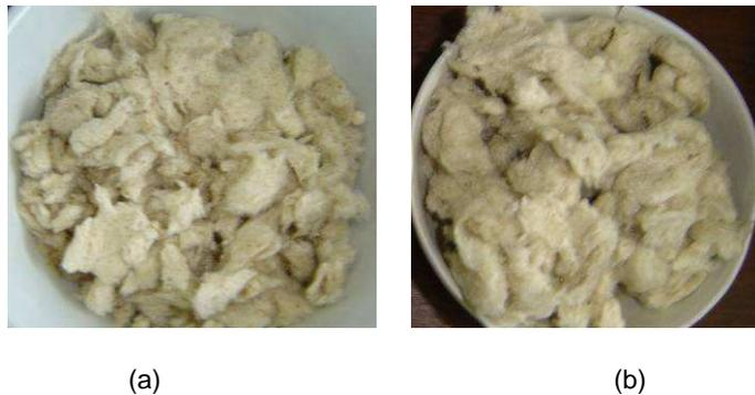
Figura 5.53 – Fibra de escória após aquecimento de: (a) 400°C; (b) 600°C.
