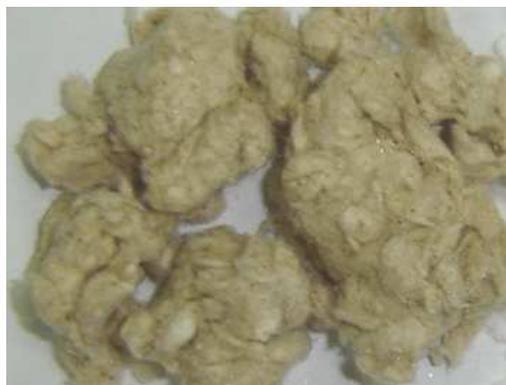
Figura 3.7 – Fibra de escória de alto-forno: Fiberfrax (UNIFRAX, 2008).
