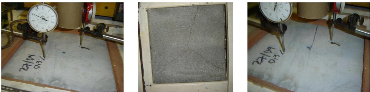
Figura 4.18 – Ensaio de impacto: (a) Placa antes da queda da esfera; (b) Primeira fissura na parte inferior; (c) Primeira fissura na parte superior.
