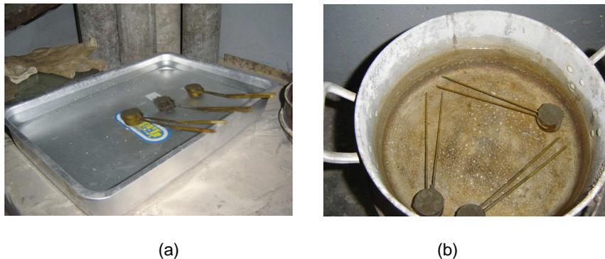
Figura 4.4 – Ensaio de Le Chatelier: (a) Cura a frio e (b) Cura a quente.
