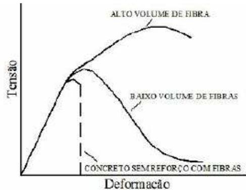
Figura 2.4 – Curvas típicas de tensão x deformação para ausência, baixo e alto teor de fibras (NUNES; AGOPYAN, 1998).
