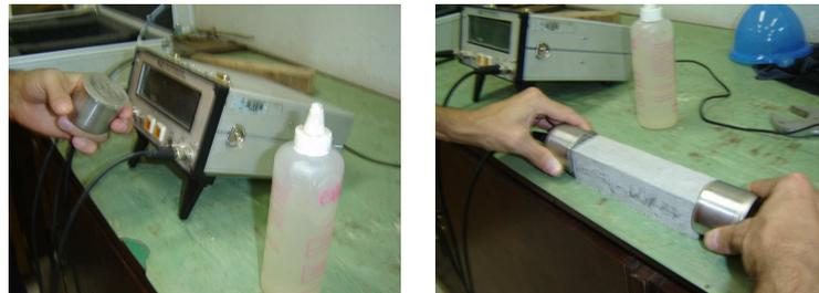
Figura 4.11 – Ensaio de módulo de elasticidade dinâmico: (a) Passagem de camada de gel sobre os transdutores; (b) Ensaio sendo realizado.
