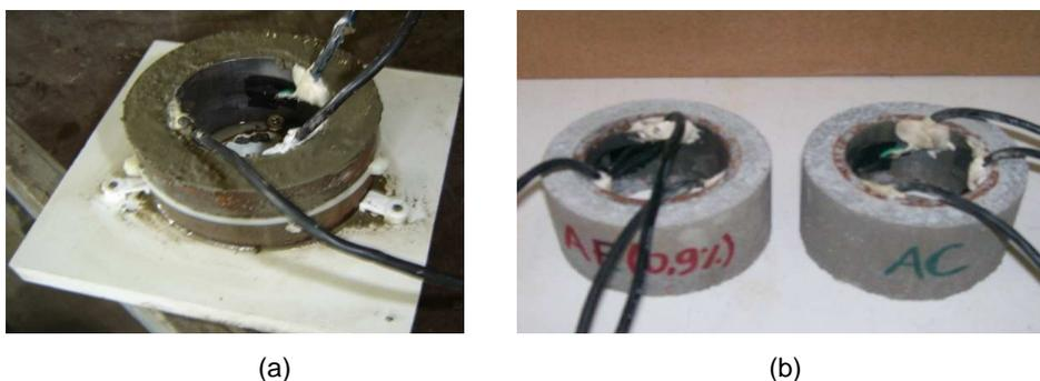
Figura 4.14 – Anéis de argamassa: (a) Moldagem; (b) Corpos-de-prova de argamassa após a retirada do anel externo.
