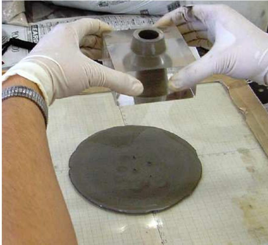
Figura 11: demonstração do ensaio de miniabatimento em andamento (MONTE, 2003, p. 25)
