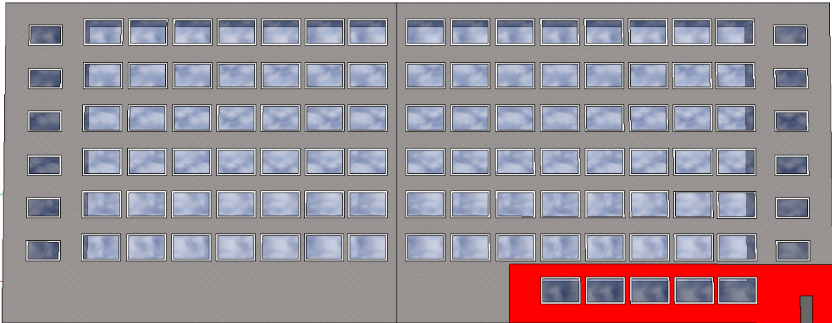
Figura 44: área onde foi executado o levantamento de manifestações patológicas através do ensaio de percussão
