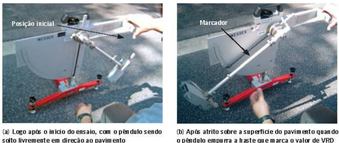
Figura 5: operação do pêndulo britânico para a determinação do valor de resistência à derrapagem (BERNUCCI et al., 2006, p. 431).
