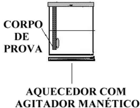
Figura 3: Representação esquemática da célula utilizada para deposição autocatalítica do níquel.
