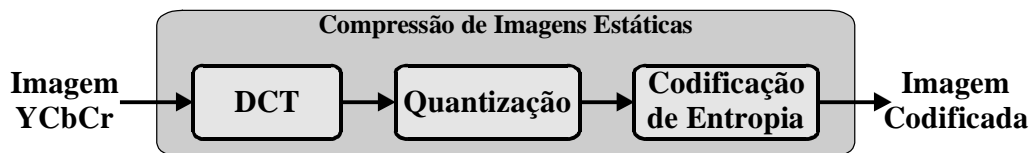
FIGURA 2.3 – Diagrama em blocos da compressão de imagens.
