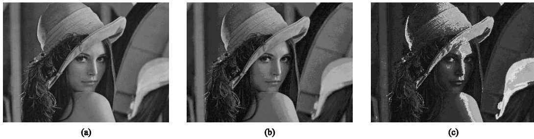
FIGURA 5.13 – (a) Imagem representada em 8 bits . (b) A mesma imagem representada em 4 bits .(c) Apenas a luminância representada em 4 bits .
