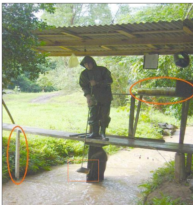
Figura 6.8. Vista geral da seção de monitoramento, durante um evento de pequena magnitude, onde é possível visualizar uma coleta com amostrador a vau USDH-48.
