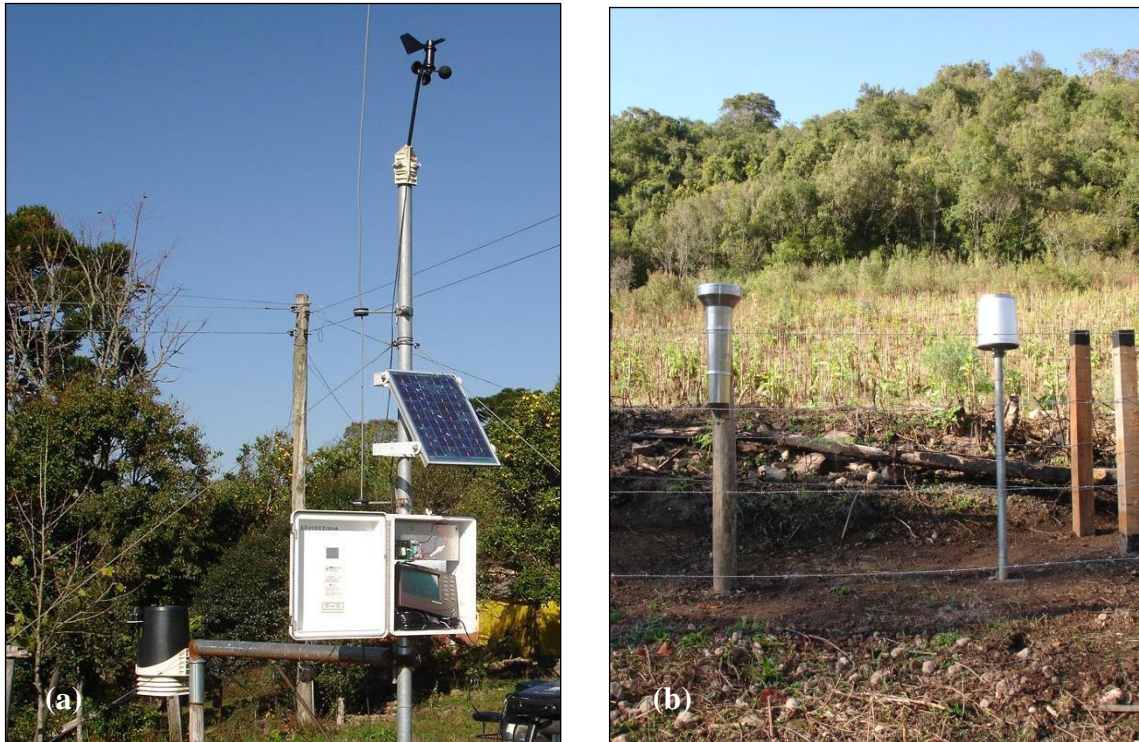
Figura 6.6. Vista geral da localização da (a) estação meteorológica com o conjunto contendo painel solar e o datalogger e (b) vista de um pluviógrafo e um pluviômetro.
