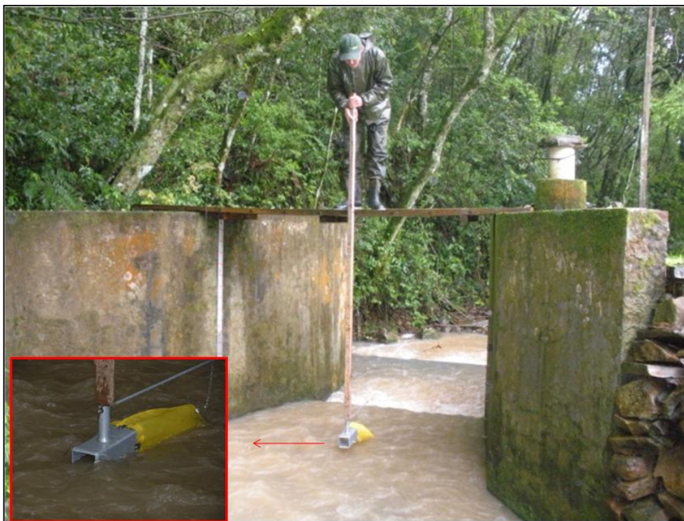
Figura 6.9. Vista da calha Parshall, onde é possível visualizar uma coleta com amostrador a vau BLH-84.
