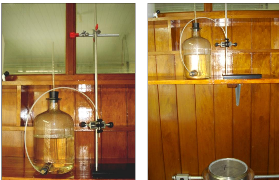
Figura 6.14. Ilustração do dispositivo para determinação da estabilidade de agregados.
