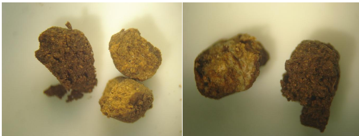
Figura 7.6. Foto ilustrando agregados rompidos pelo impacto da gota.
