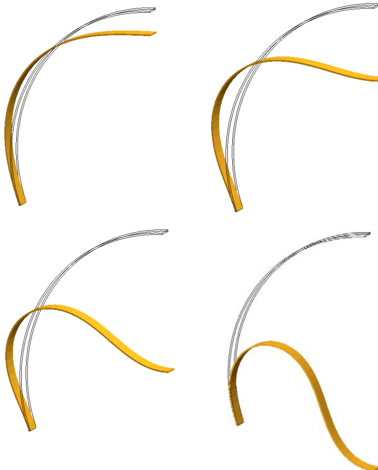
FIGURA 7.34 – Configurações deformadas reais do arco circular em instantes com deslocamento vertical igual a 13; 38; 78; 140 no ponto central.
