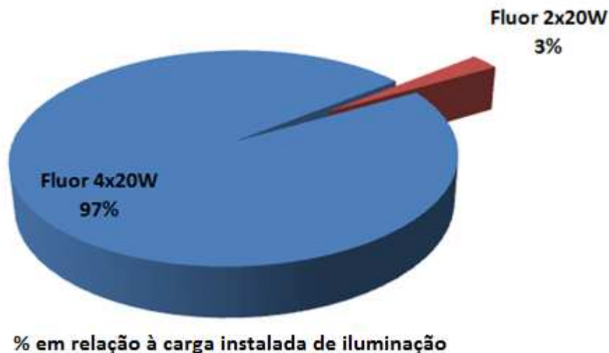
Figura 44. Distribuição da carga de iluminação ineficiente.
