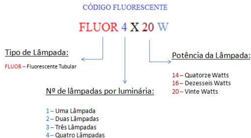
Figura 39. Código para a tipologia de lâmpadas fluorescentes tubulares.
