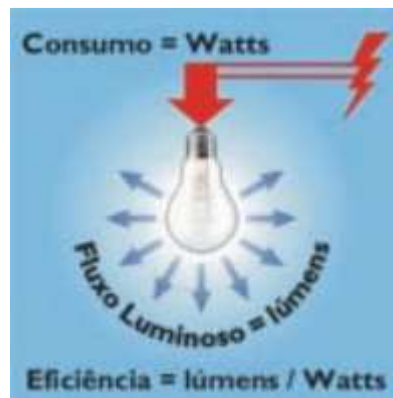
Figura 13. Ilustração da Eficiência de uma lâmpada. Fonte: (9) PHILIPS – Guia de Iluminação 2005.
