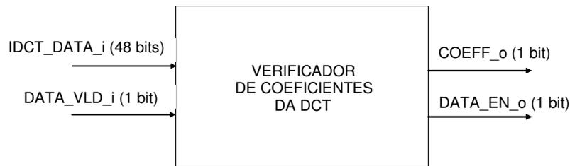
Figura 17 Verificador de coeficientes da IDCT.
